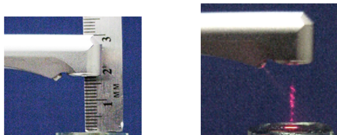
Figura 8 – A. Padronização da distância de atuação do laser (12 mm); B. Preparo cavitário
