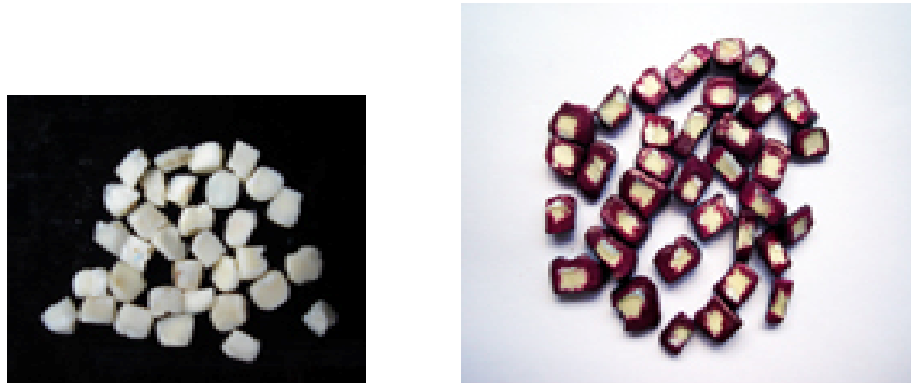
Figura 4 – A. Espécimes padronizados com 2,0 mm de espessura em dentina; B. Espécimes impermeabilizados com 2 camadas de verniz ácido resistente
