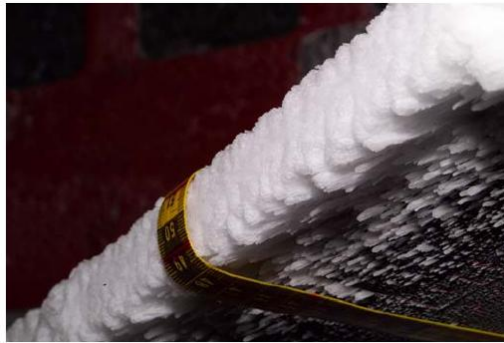
Figura A.5: Forma de gelo real do tipo rime em aerofólio NACA 0012 com enflechamento de 45° (VARGAS; TSAO, 2007)
