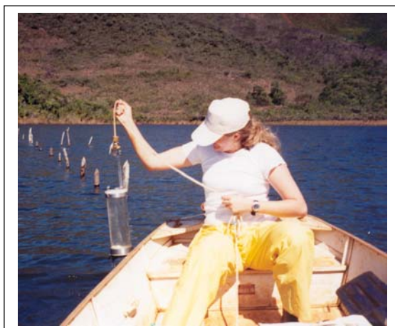
Figura 2.4 - Amostrador vertical Limnos utilizado na coleta das amostras de água.
