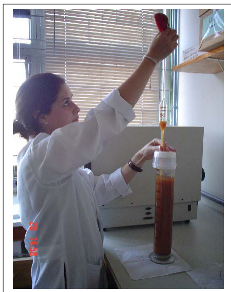
Figura 2.6 – Análise Granulométrica pelo método da pipeta
