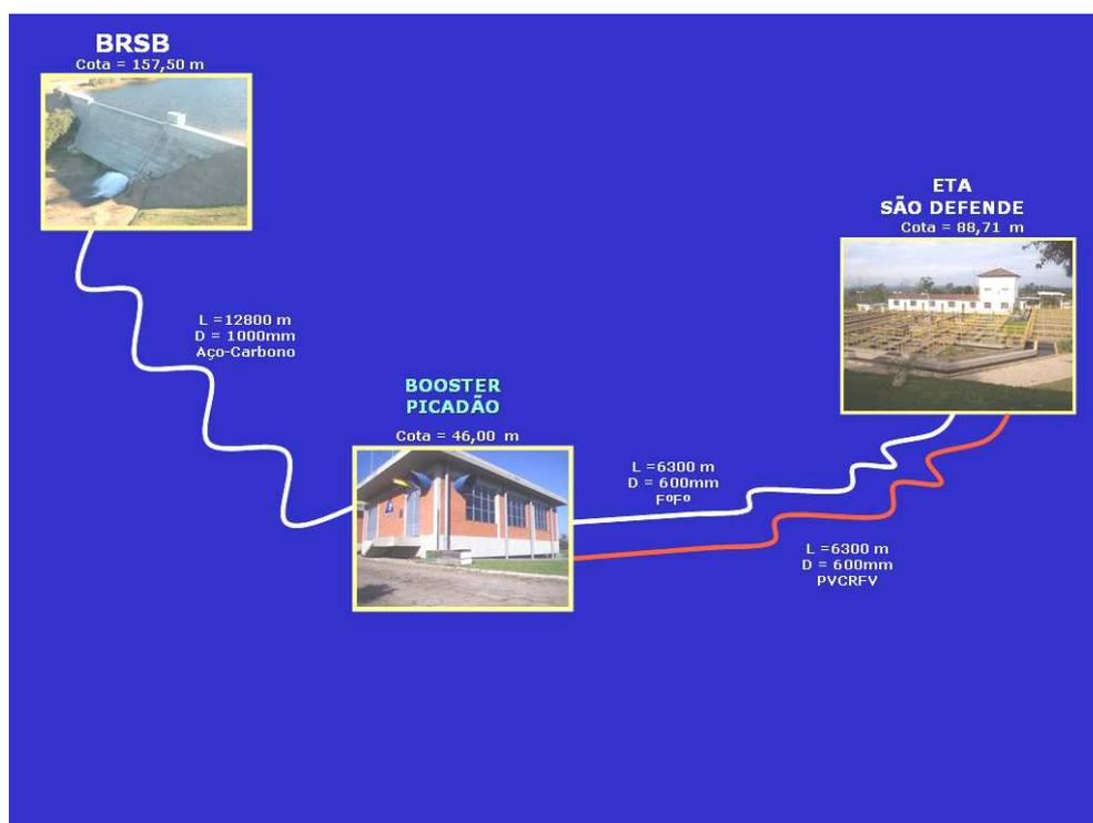
Figura 21. Esquema do sistema adutor da barragem do rio São Bento.
