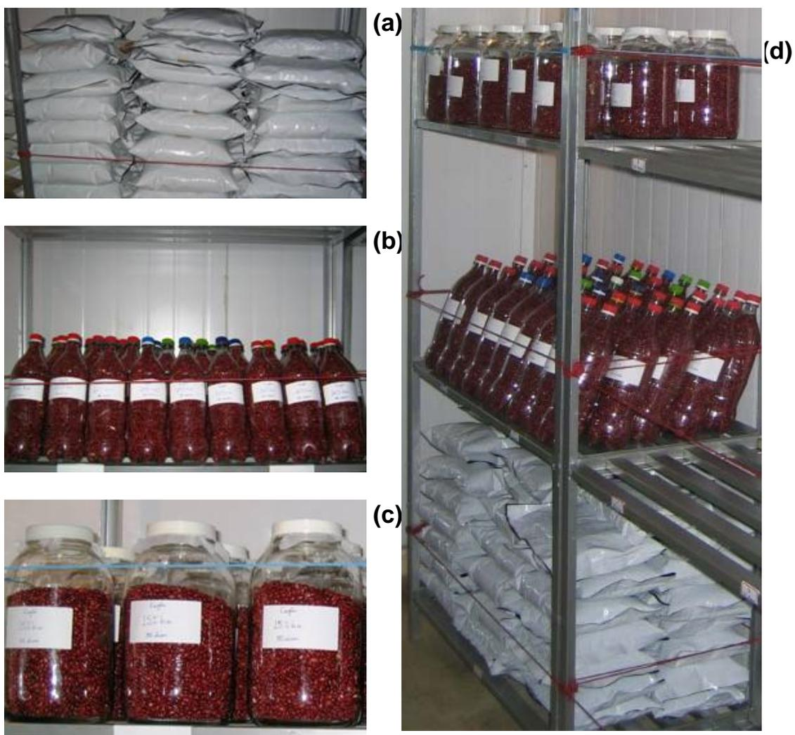
Figura 1 – Silo tipo bolsa (a); garrafa pet (b); testemunha (c); embalagens dispostas em estante no interior da câmara climática (d).
