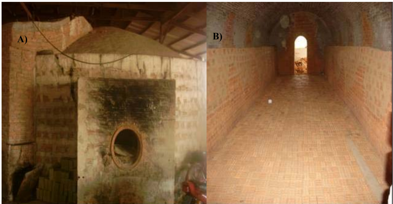
Figura 5.11 – Fornos de Abóbora: A) Imagem externa do forno, B) Imagem interna do forno de abóboda.
