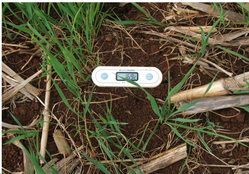
Figura 5 - Termômetro digital com haste de metal, utilizado para aferição da temperatura do solo a 10 cm de profundidade em cada ponto de coleta de solo.
