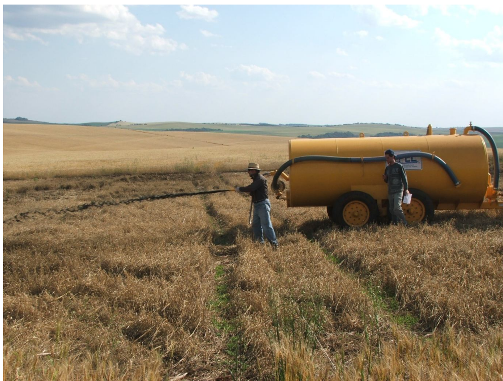
Figura 2 – Distribuidor de dejeito líquido de suínos utilizado para a aplicação do dejeito na área experimental.
