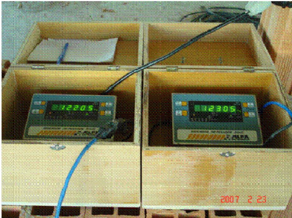
**Figura 4.6 – Indicadores de carga interligados às células**
