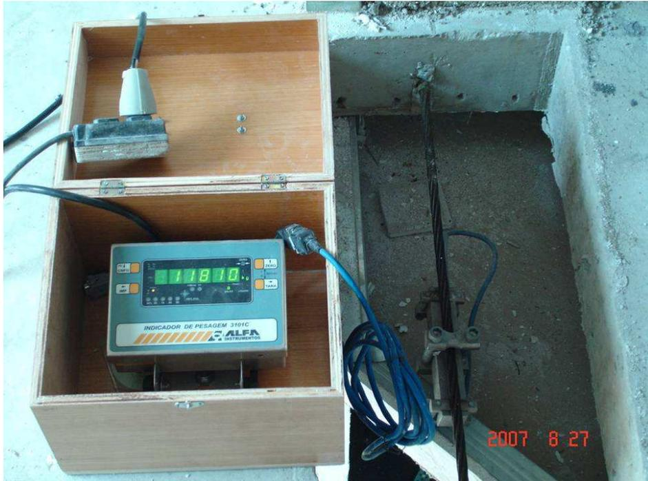
**Figura 4.7** – Indicador de carga interligado à célula
