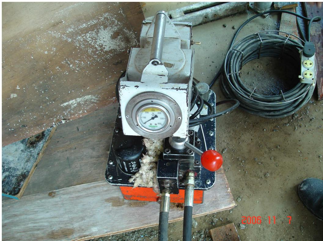
**Figura 2.10** – Detalhe da bomba hidráulica para protensão
