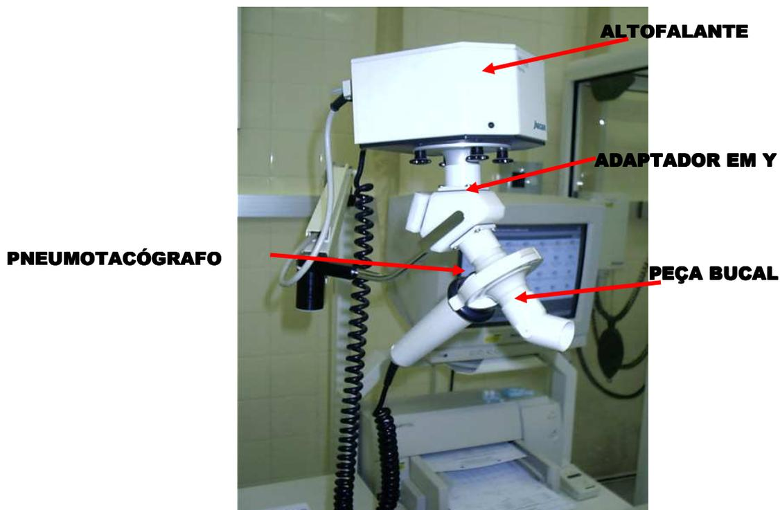
Fig. 3. Equipamento Master Screen IOS Jaeger
