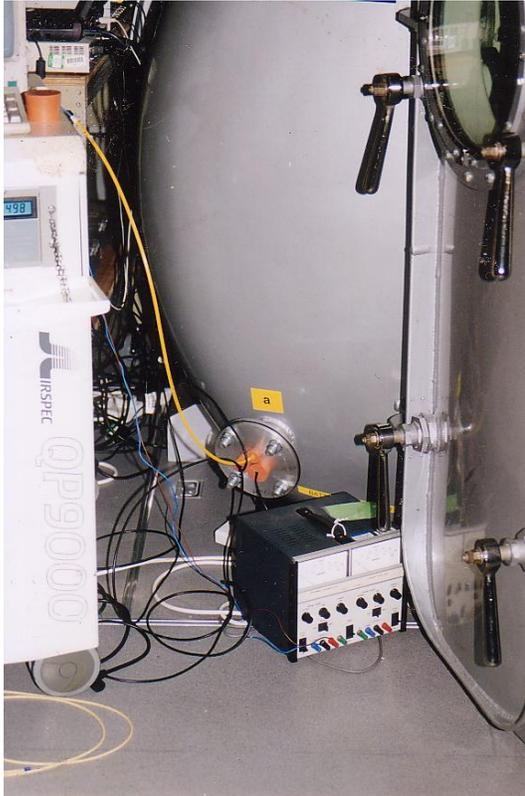
Figura 20 ó Exterior da câmara, local de passagem de cabos e sensores para interior da câmara sem alterar as condições de pressão estabelecidas. Visão parcial do espectrômetro, à esquerda.
