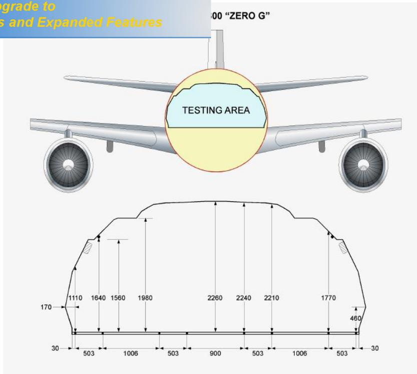
Figura 7 ó A-300, área de testes, dimensões em milímetros.
