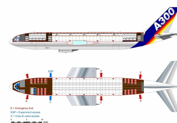
Figura 6 ó A-300, configuração interna da aeronave. Portas para acesso das pessoas (C) e equipamentos (EXP). Assentos para decolagem e pouso (extremidades). Saídas de emergência (E). Área de testes (centro).
