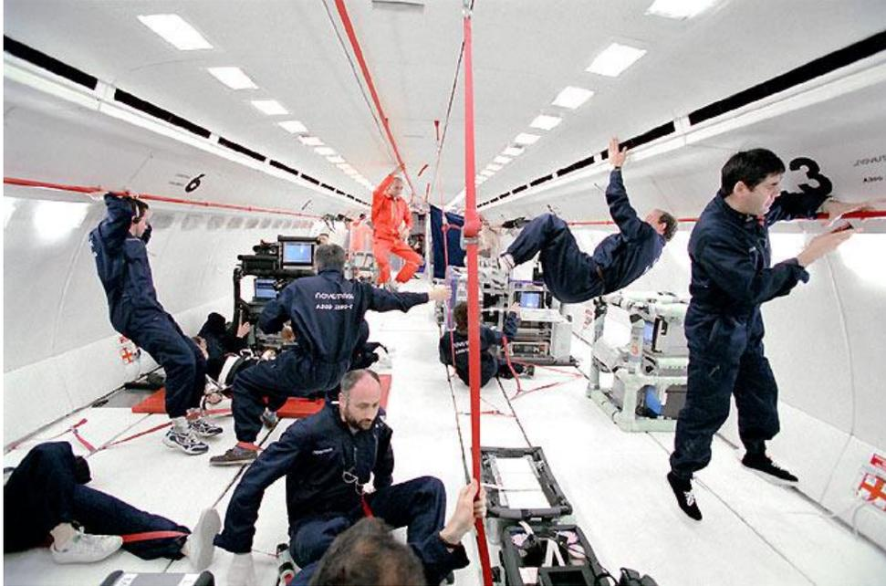
Figura 13 ó Área de testes durante a microgravidade. A iluminação da cabine se mantém uniforme durante o vôo. Paredes laterais, superior e inferior acolchoadas.
