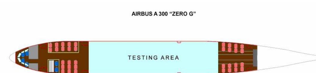
Figura 8 ó A-300, área de testes (central), assentos para decolagem e pouso (extremidades). Cabine de comando na extremidade (à esquerda).
