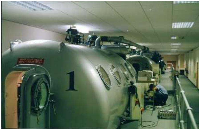
Figura 18 ó Câmara hipobárica Aeroform, localizada na Base de Henlow, Inglaterra.
