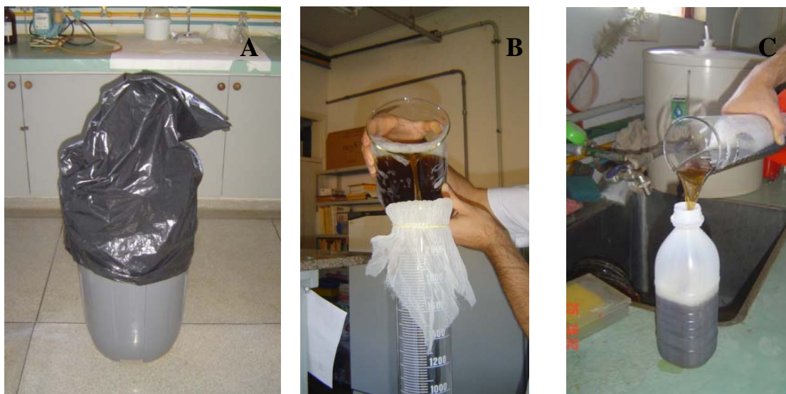
Figura 3. Etapas da preparação do extrato lixiviado. (A) Extração aquosa na ausência de luz. (B) Passagem por peneiras. (C) Fracionamento em recipientes plásticos.
