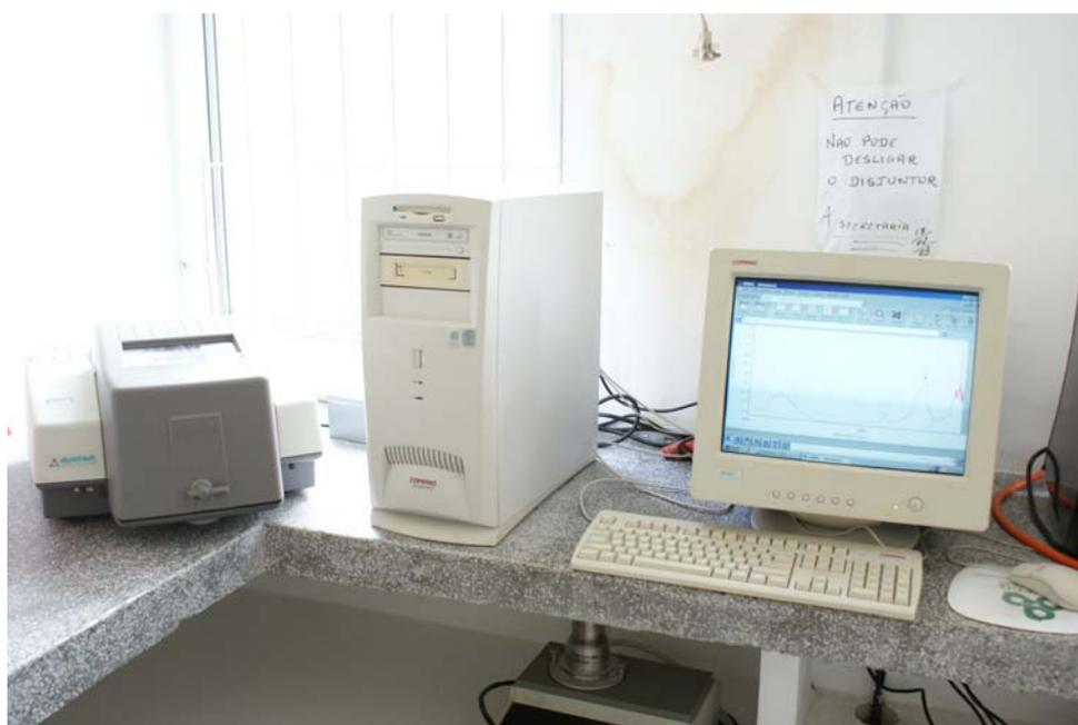
Figura 13 – Espectrofotômetro de IR TM 360 FT-IR
