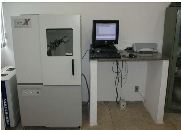
Figura 12 – Difratormetro de raios X XRD6000.
