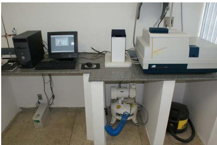
Figura 10 – Granulometro à laser CILAS 1064
