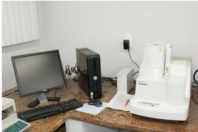
Figura 14 – Analisador térmico TA 60h
