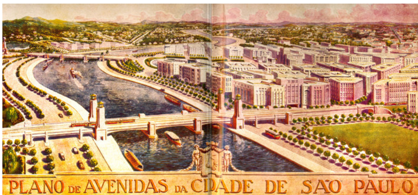
Figura 16 –Calha do rio Tietê retificada no Plano de Avenidas, de 1929. Detalhe da proposta de ocupação de antigas áreas de várzea com estruturas de circulação rodoviárias e de transporte. Fonte: Toledo (1996).
