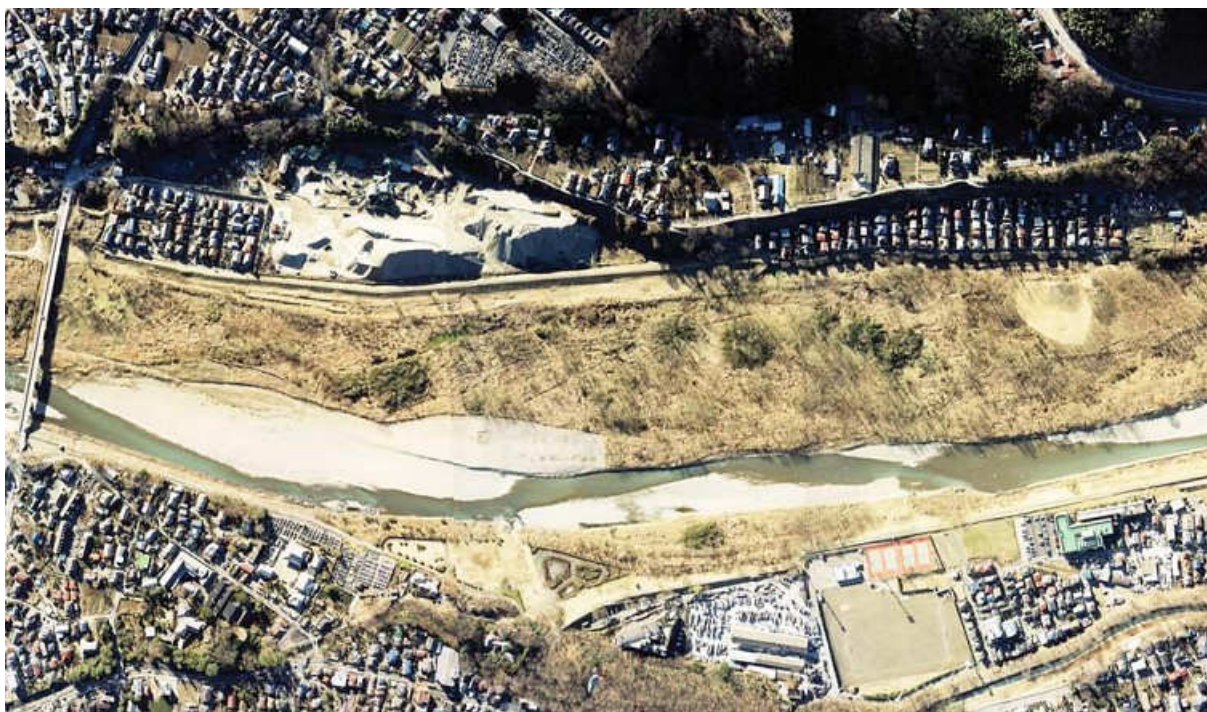
Figura 5 – Rio Tama, em 2002. O processo de restauração reverteu o assoreamento (com remoção de sedimentos do leito do rio), além de proporcionar o crescimento de espécies nativas. Fonte: Nakamura; Tockner; Amano, 2006.
