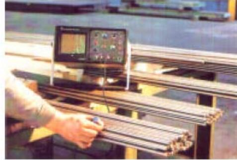
Figura I-22 – Varreduras do feixe sônico em Barras Cilíndricas Forjadas [11]
