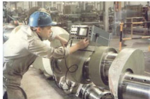
Figura I-24 – Varreduras do feixe sônico em Forjados Retangulares e Quadrados [11]
