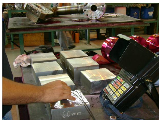
Figura II.7 – Ensaio por ultra-som nas matérias-primas
