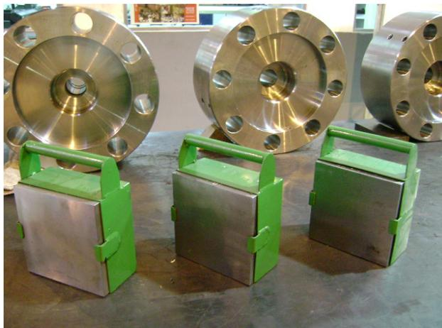
Figura II.3 – Fotos dos CP's encapsulados em caixa metálica
