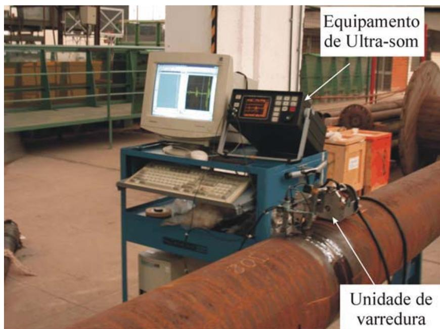
Figura I.37 – Equipamento utilizado no Ensaio de TOFD [22]
