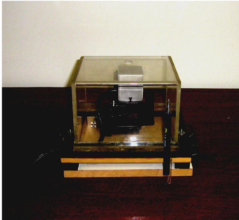
Figura 4.4b: Protótipo nº1 encerrado numa caixa acrílica. A caneta ao lado evidencia a compactação alcançada com este primeiro modelo.
