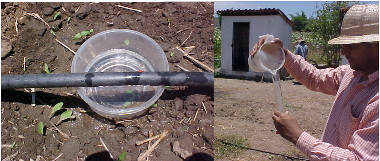
Figura 10 – Obtenção das vazões de quatro gotejadores ao longo da linha lateral e de quatro linhas laterais, para determinação do coeficiente de uniformidade de aplicação C_u (Keller; Karmeli, 1975)
