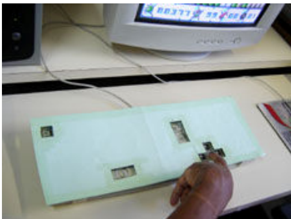
Figura 63: Máscara de teclado com poucas teclas expostas
