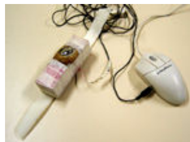
Figura 105: Switches para acionamento com a cabeça, feito com botão grande de sucata
