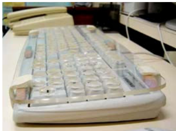
Figura 62: Máscara de teclado sobreposta ao mesmo
