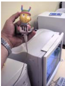
Figura 101: Microfone com brinquedo de pressão acoplado
