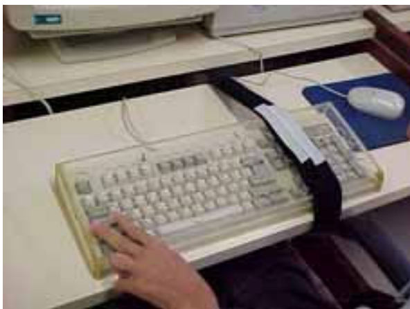
Figura 61: Máscara de teclado encaixada no mesmo
