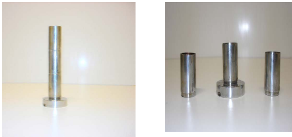
Figura 3.5. Aparato utilizado na estabilidade à estocagem.
