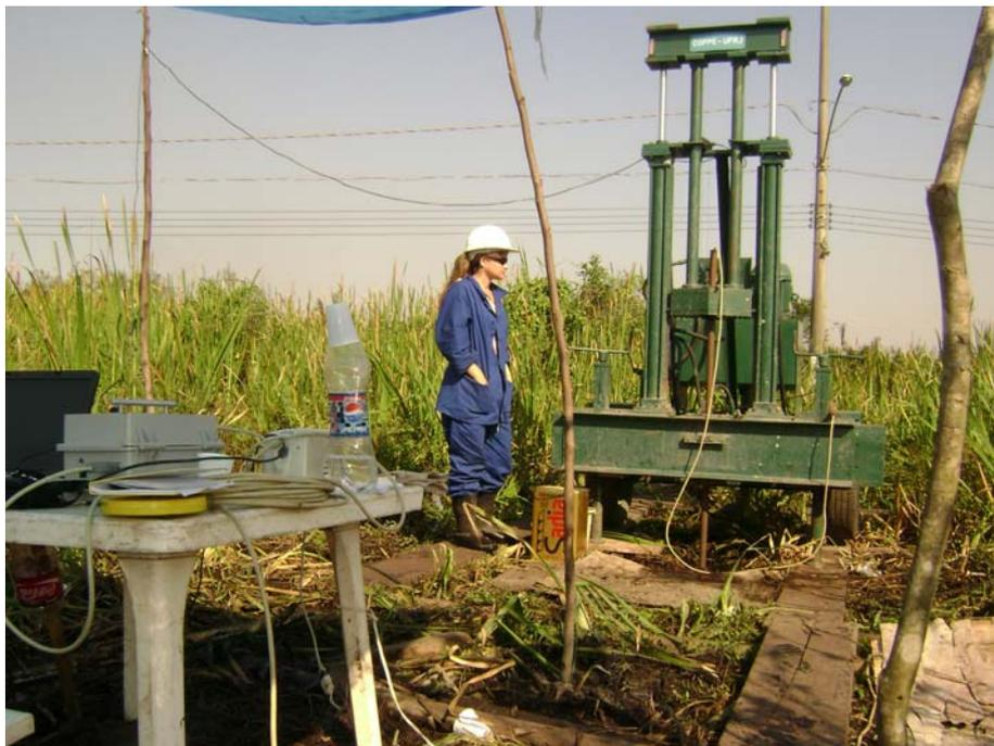
Figura 4.24 – Máquina de cravação com ensaio em andamento.
