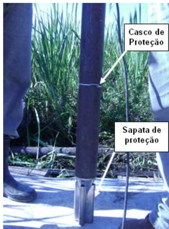
Figura 4.14 – Casco e sapata de proteção.
