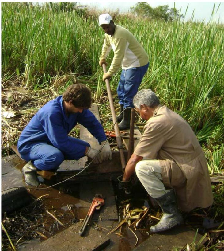
Figura 4.7 – Preparação de ensaio de palheta, observando-se o nível d'água admitido igual ao nível do terreno.
