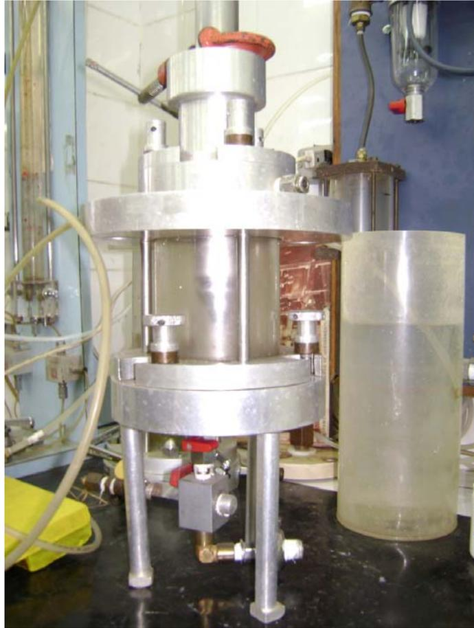
Figura 4.26 – Recipiente pressurizado empregado para calibrar os transdutores de poro-
