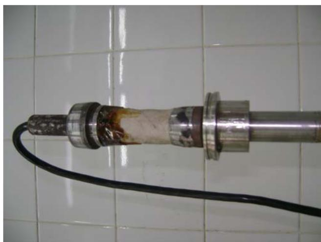
Figura 4.17 – Célula de torque de 100 Nm, que substituiu a danificada.
