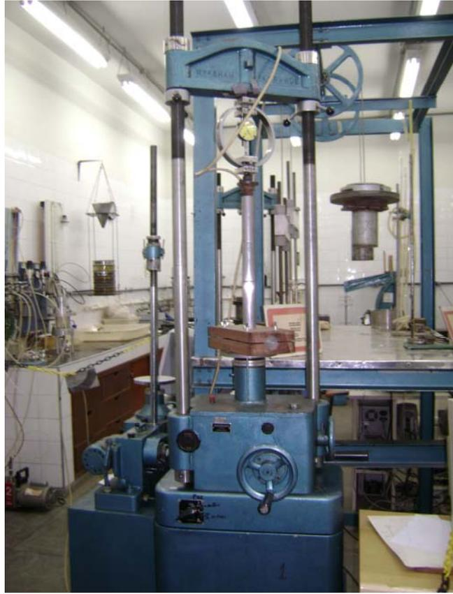
Figura 4.33 – Calibração da célula de carga da barra cilíndrica, em prensa do Laboratório de Geotecnia.
