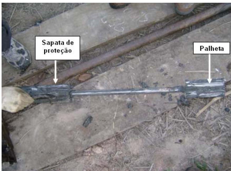
Figura 4.12 – Palheta fora da sapata de proteção.
