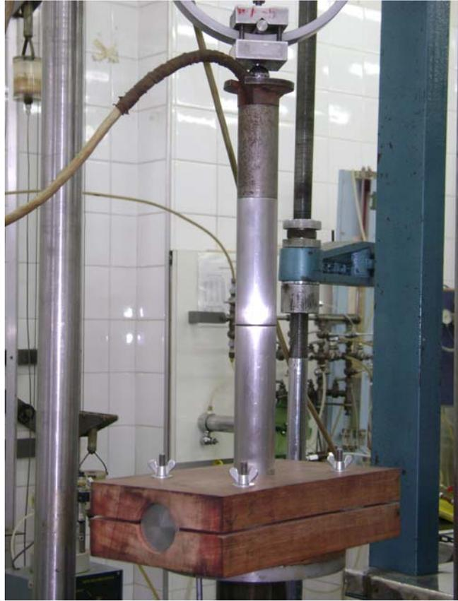
Figura 4.34 – Detalhe de fixação da barra cilíndrica na prensa.
