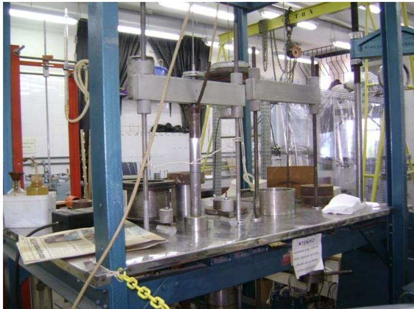
Figura 4.25 – Pendural utilizado para calibrar as células de carga de ponta e atrito.
