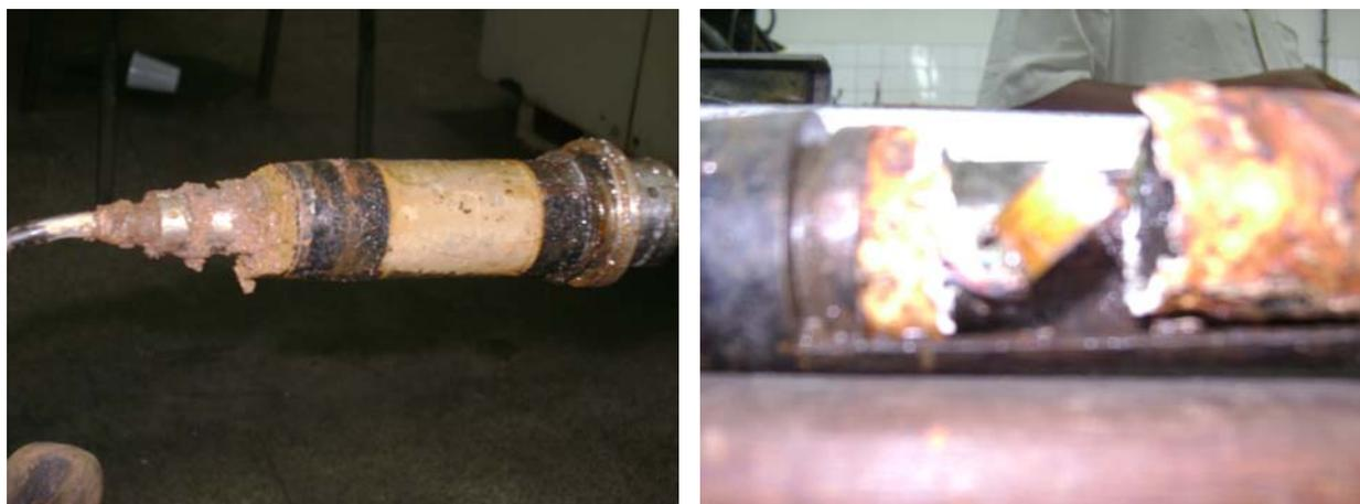
Figura 4.16 – Célula de torque danificada: (a) impurezas no sistema; (b) célula rompida.
