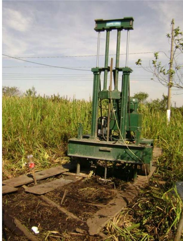
Figura 4.32 – Ensaio de barra cilíndrica em andamento.
