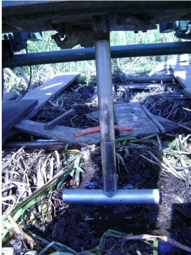
Figura 4.31 – Barra cilíndrica (T-bar) antes da penetração no solo, no início do ensaio.
