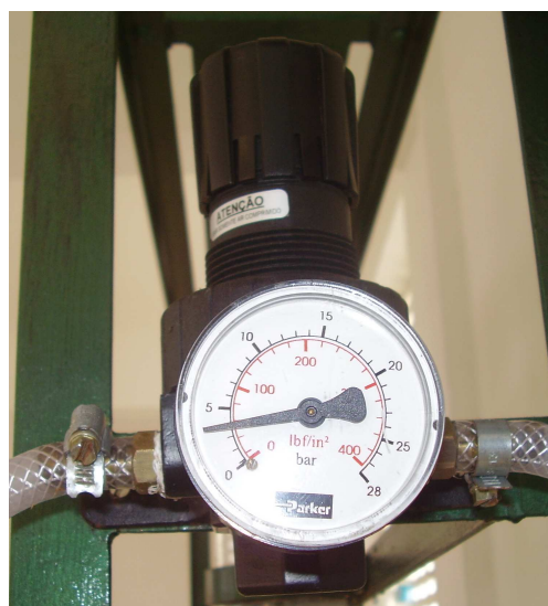
Figura 4.7. Válvula reguladora de pressão.
