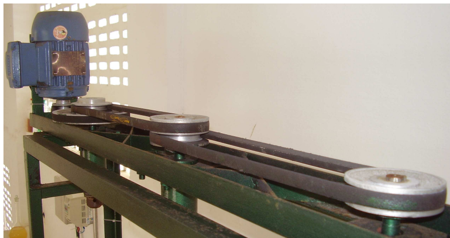
Figura 4.6. Conjunto motor e polias que movimentam os eixos.
