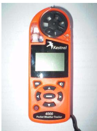
FIGURA 6 – Termoanemômetro (Marca Nielsen-Kellerman, Modelo Kestrel 4000) programado para monitorar e registrar as condições climáticas durante o transporte de frangos da granja ao abatedouro e descanso pré-abate.
