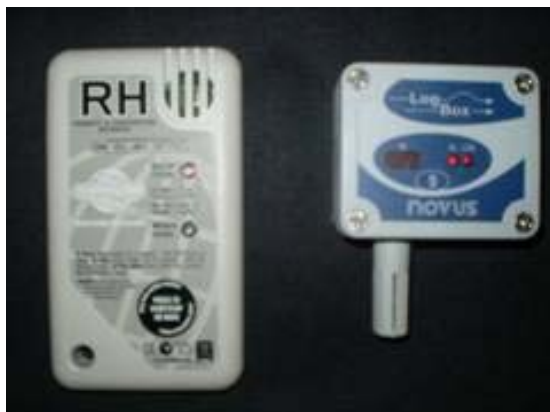
FIGURA 3 – Termohigrômetros Temprecord-RHT (Marca Didai tecnologia) e LogBox-RHT (Marca Novus) programados para monitorar e registrar as condições climáticas durante o transporte de frangos da granja ao abatedouro e descanso pré-abate.
