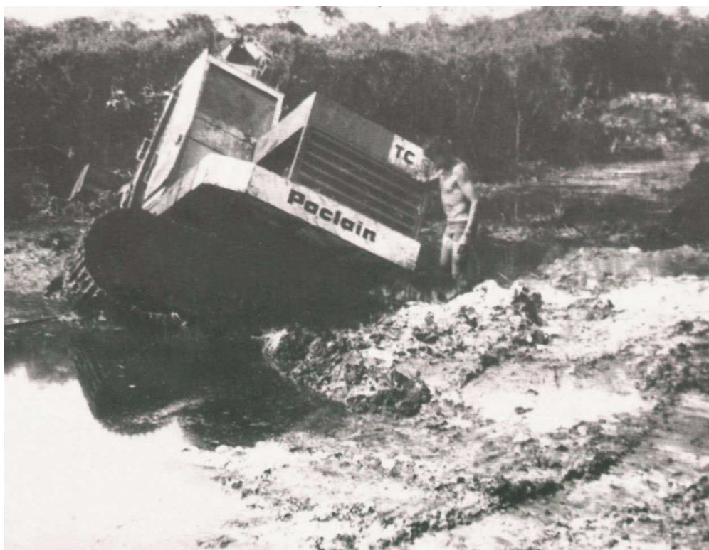
Figura 5 – Trator atolado no solo arenoso e encharcado Fonte: Calis, Silva e Siqueira (2002, p. 82)
