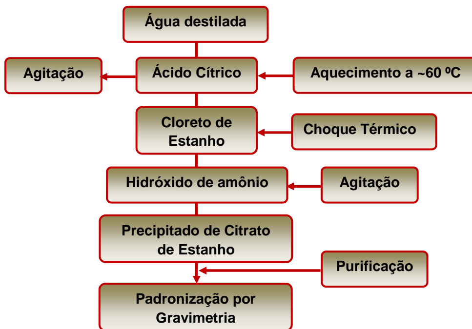
Figura 4.1 – Esquema da preparação de citrato de estanho.
