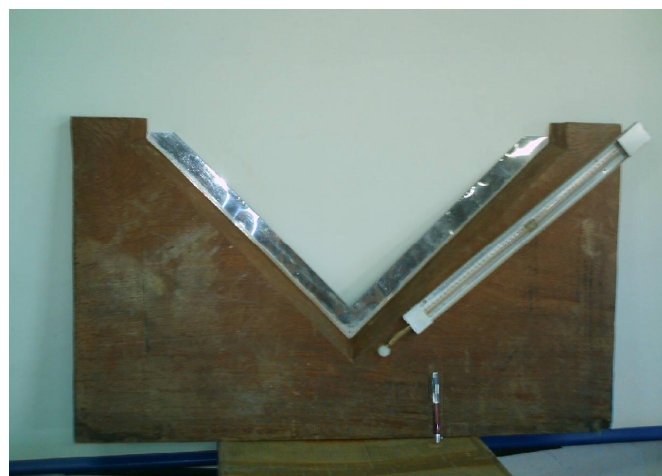
Figura 4.10 - Vertedor triangular, pertencente ao Laboratório de Hidráulica da Escola de Minas.
