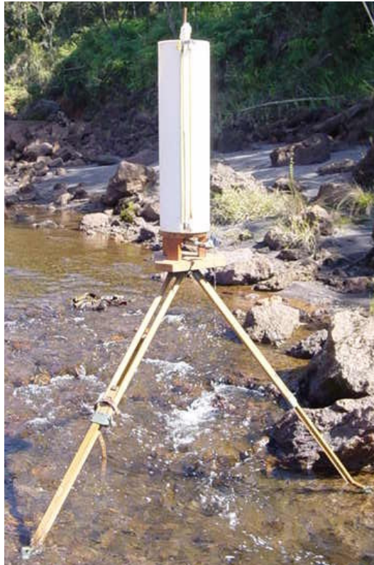
Figura 4.2 - Frasco de Mariotte em operação em teste conduzido para avaliar a influência da injeção.
