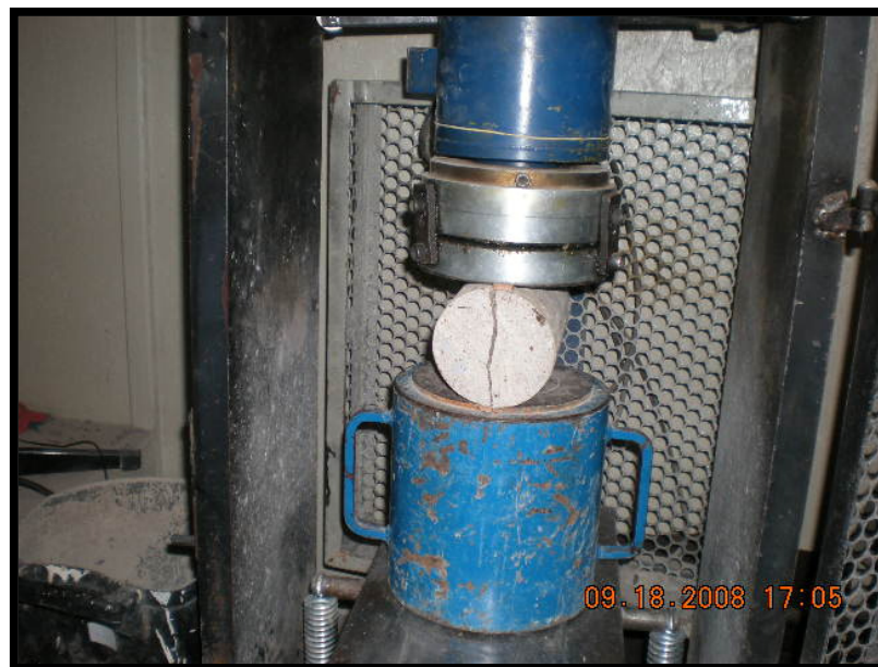
Fig 5.14. Corpo de prova rompido por tração diametral. Fonte: CONSAG, 2008.
