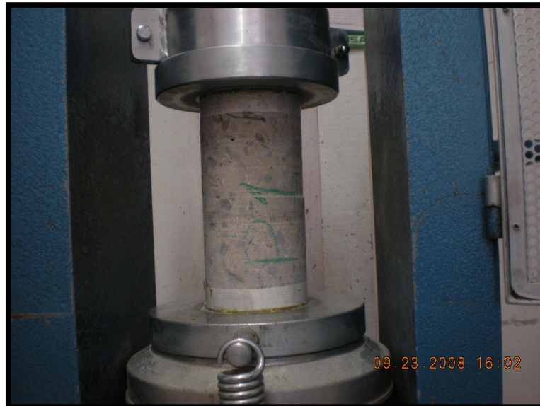
Fig 5.10. Regularização de face com disco de neoprene. Fonte: CONSAG, 2008.
