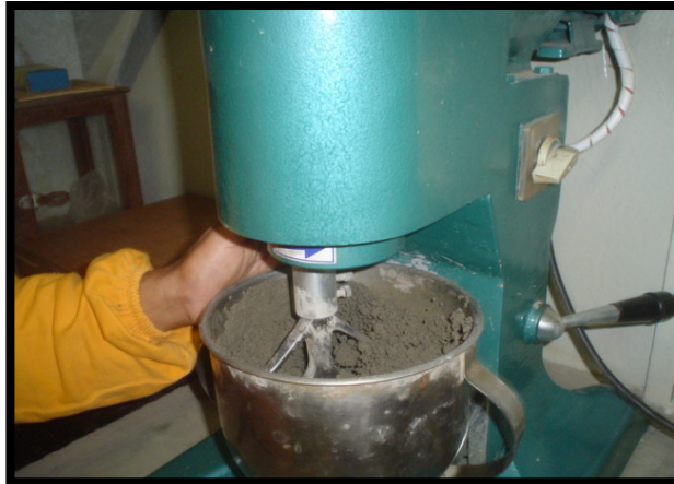
Fig 5.1. Mistura de argamassa para moldagem. Fonte: CONSAG, 2008.
