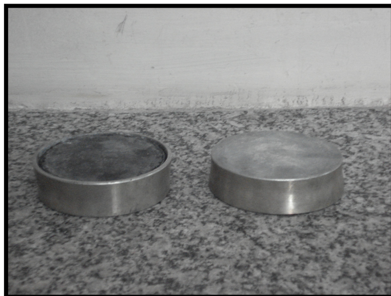
Fig 5.9. Disco de neoprene – Substitui capeamento com enxofre. Fonte: ALVES, 2008.
