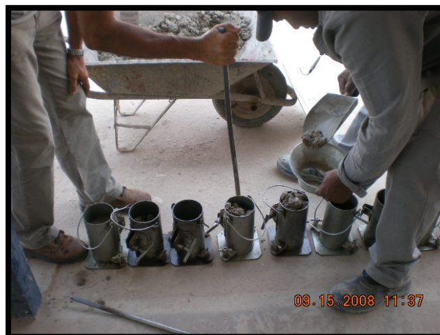
Fig 5.3. Moldagem dos corpos de prova de concreto. Fonte: CONSAG, 2008.
