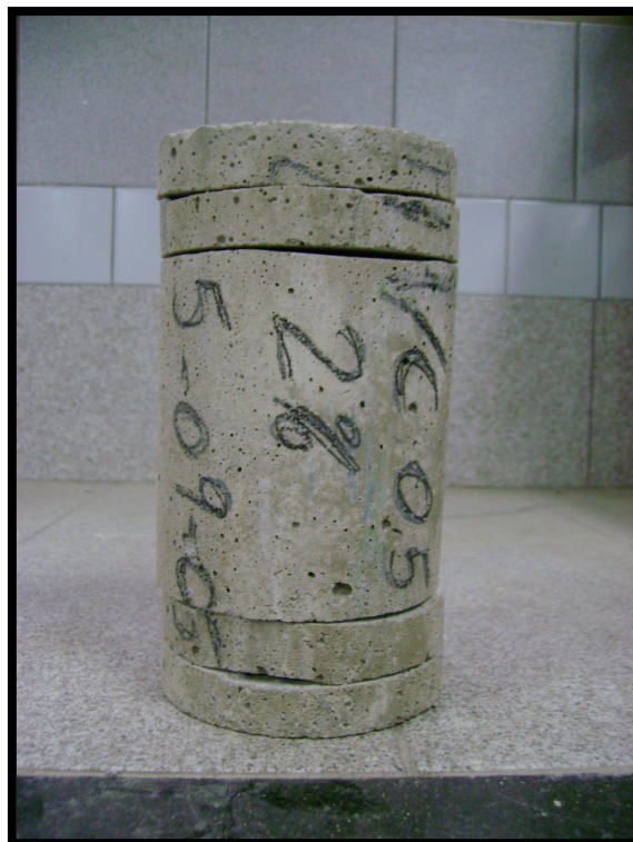
Fig. 5.5. Corpo de prova para determinação da permeabilidade.
