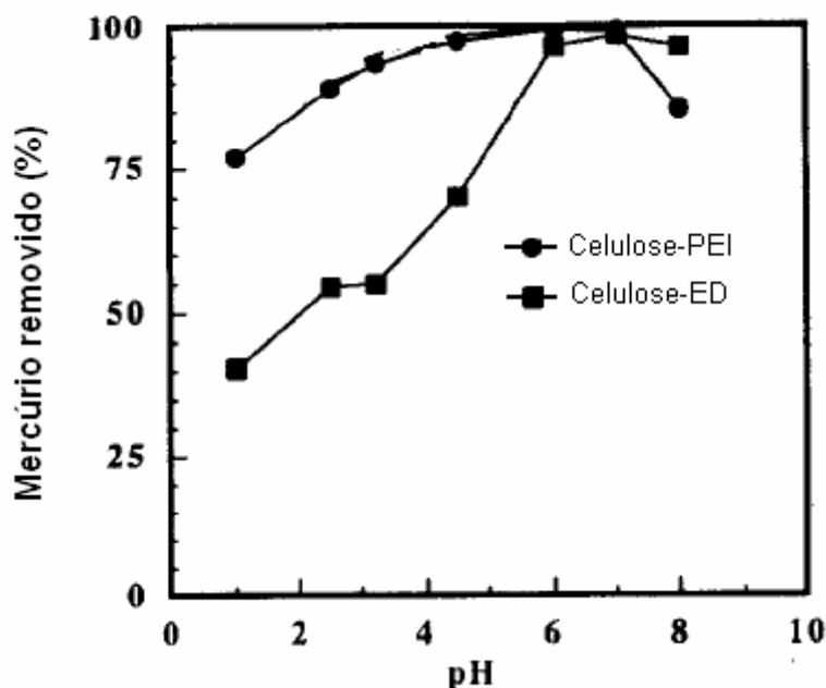
Figura 3.10. Efeito do pH na adsorção de  $Hg^{2+}$  pela celulose-PEI e pela celulose-ED.
