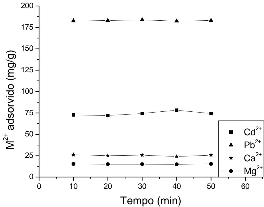
Figura 5.24. Cinética de adsorção de Cd<sup>2+</sup>, Pb<sup>2+</sup>, Ca<sup>2+</sup> e Mg<sup>2+</sup> por CTE.
