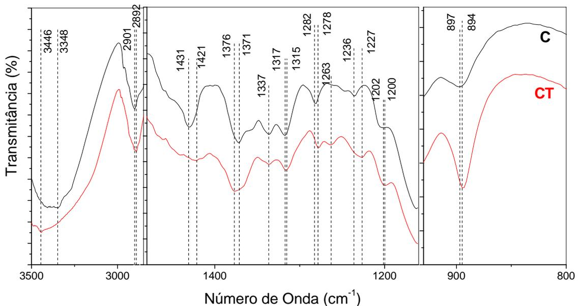
Figura 5.2. Espectro na região do infravermelho de **C** e **CT**
