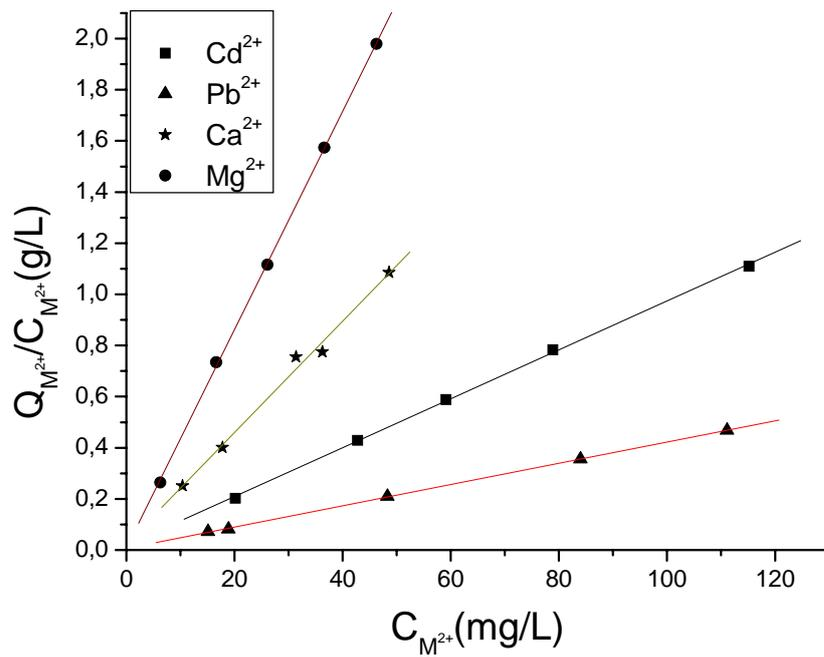
Figura 5.30. Gráfico da isoterma de Langmuir linearizada para a adsorção de Cd<sup>2+</sup>, Pb<sup>2+</sup>, Ca<sup>2+</sup> e Mg<sup>2+</sup> por BTTE realizada nos valores de pH mais ácido.
