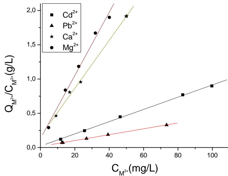
Figura 5.29. Gráfico da isoterma de Langmuir linearizada para a adsorção de Cd<sup>2+</sup>, Pb<sup>2+</sup>, Ca<sup>2+</sup> e Mg<sup>2+</sup> por CTE realizada nos valores de pH mais alcalino.
