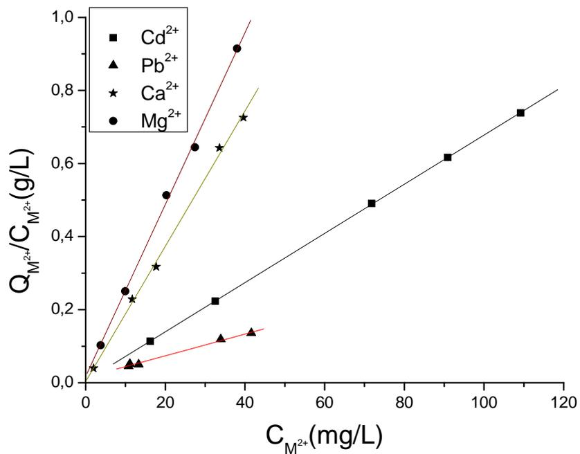
Figura 5.31. Gráfico da isoterma de Langmuir linearizada para a adsorção de Cd<sup>2+</sup>, Pb<sup>2+</sup>, Ca<sup>2+</sup> e Mg<sup>2+</sup> por BTTE realizada nos valores de pH mais alcalino.
