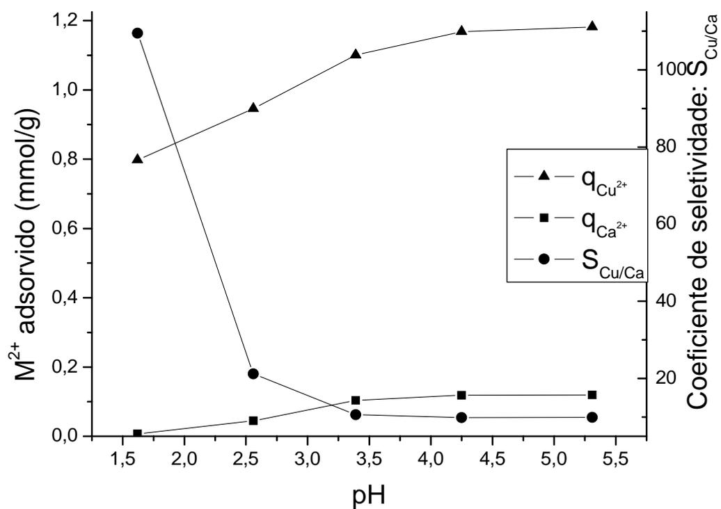
Figura 5.38. Gráfico da variação da adsorção de  $\text{Cu}^{2+}$  e  $\text{Ca}^{2+}$  e do coeficiente de seletividade pelo pH pelo BTTE.
