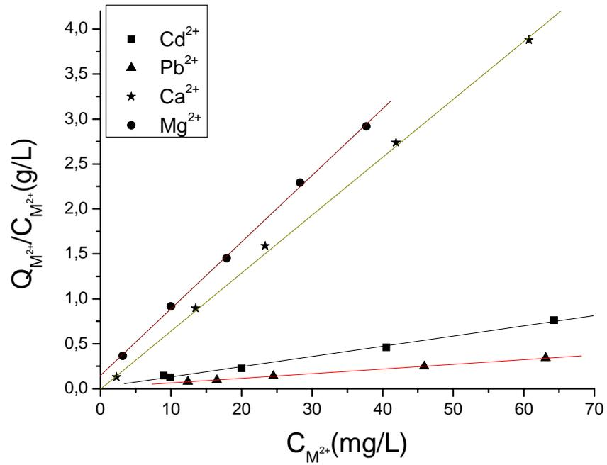
Figura 5.28. Gráfico da isoterma de Langmuir linearizada para a adsorção de Cd<sup>2+</sup>, Pb<sup>2+</sup>, Ca<sup>2+</sup> e Mg<sup>2+</sup> por CTE realizada nos valores de pH mais ácido.
