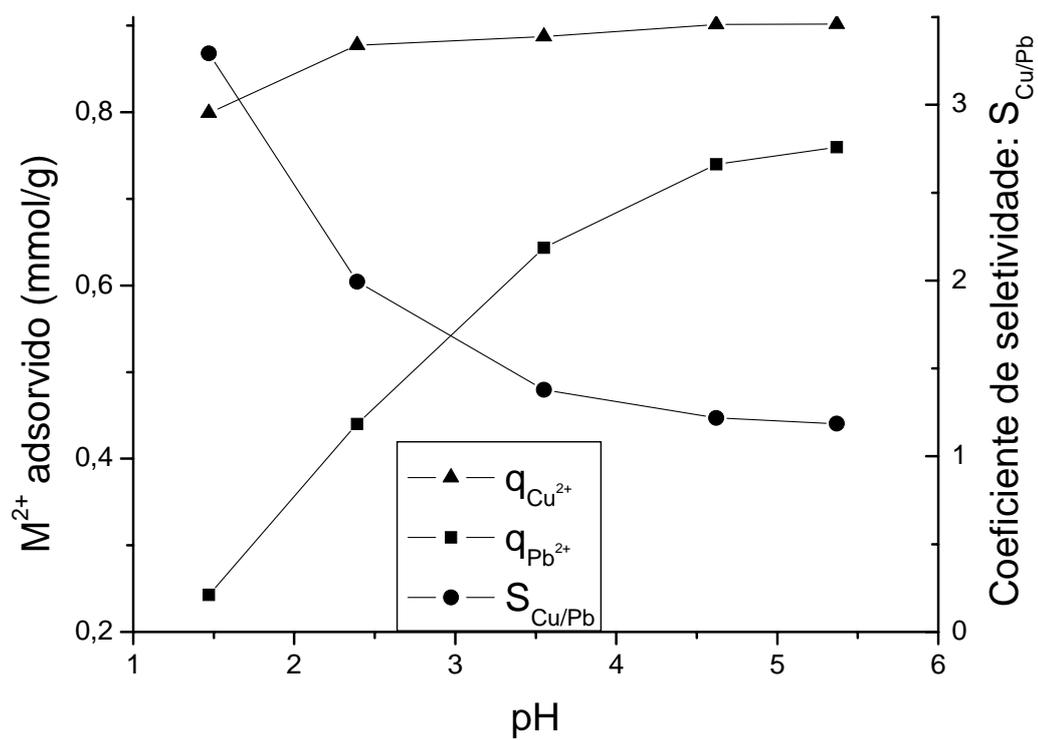
Figura 5.37. Gráfico da variação da adsorção de  $\text{Cu}^{2+}$  e  $\text{Pb}^{2+}$  e do coeficiente de seletividade pelo pH pelo BTTE.
