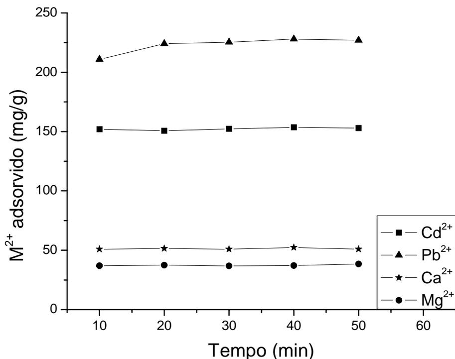
Figura 5.25. Cinética de adsorção de Cd<sup>2+</sup>, Pb<sup>2+</sup>, Ca<sup>2+</sup> e Mg<sup>2+</sup> por BTTE.
