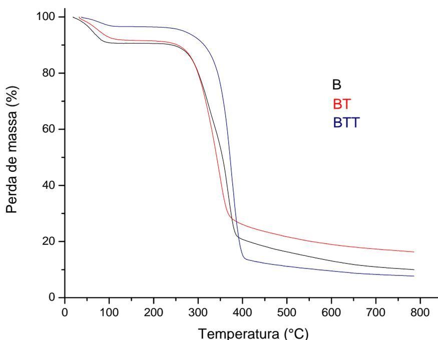
Figura 5.6. Análise termogravimétrica de **B**, **BT** e **BTT**.
