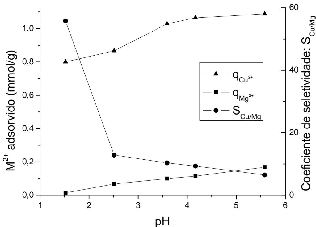
Figura 5.35. Gráfico da variação da adsorção de  $Cu^{2+}$  e  $Mg^{2+}$  e do coeficiente de seletividade pelo pH pelo CTE.
