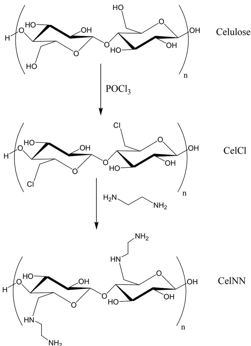
Esquema 3.4. Rota sintética para a obtenção de CelINN.
