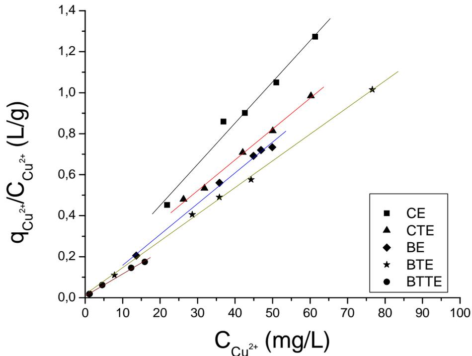
Figura 5.23. Gráfico da isoterma de Langmuir linearizada para a adsorção de  $\text{Cu}^{2+}$  por todos os materiais modificados em  $\text{pH}=5,3$
