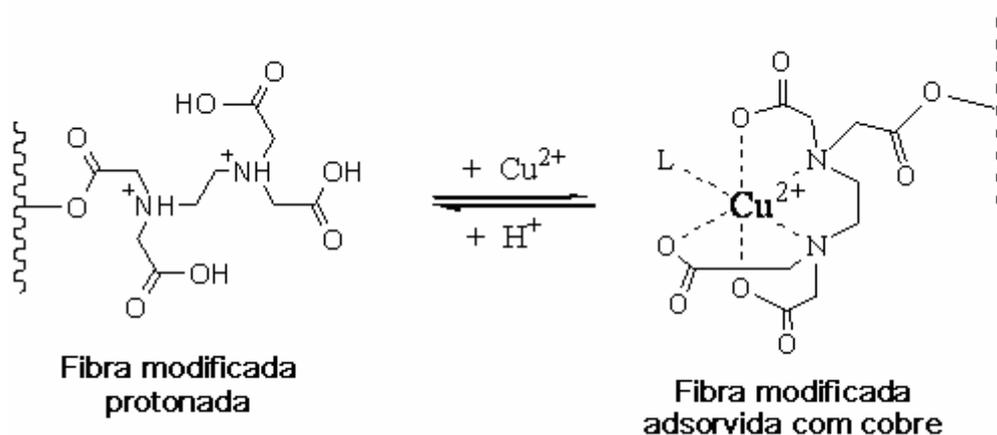
Esquema 5.3. Equilíbrio entre o cobre e o próton pelos materiais modificados.
