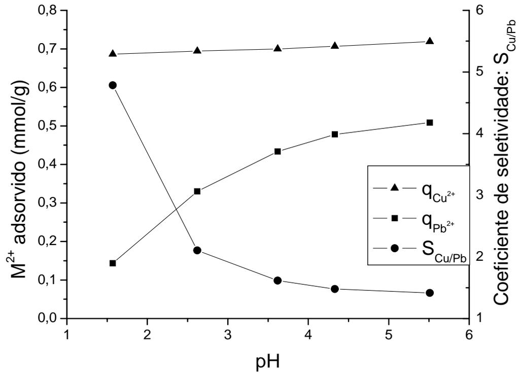
Figura 5.33. Gráfico da variação da adsorção de  $\text{Cu}^{2+}$  e  $\text{Pb}^{2+}$  e do coeficiente de seletividade pelo pH pelo CTE.
