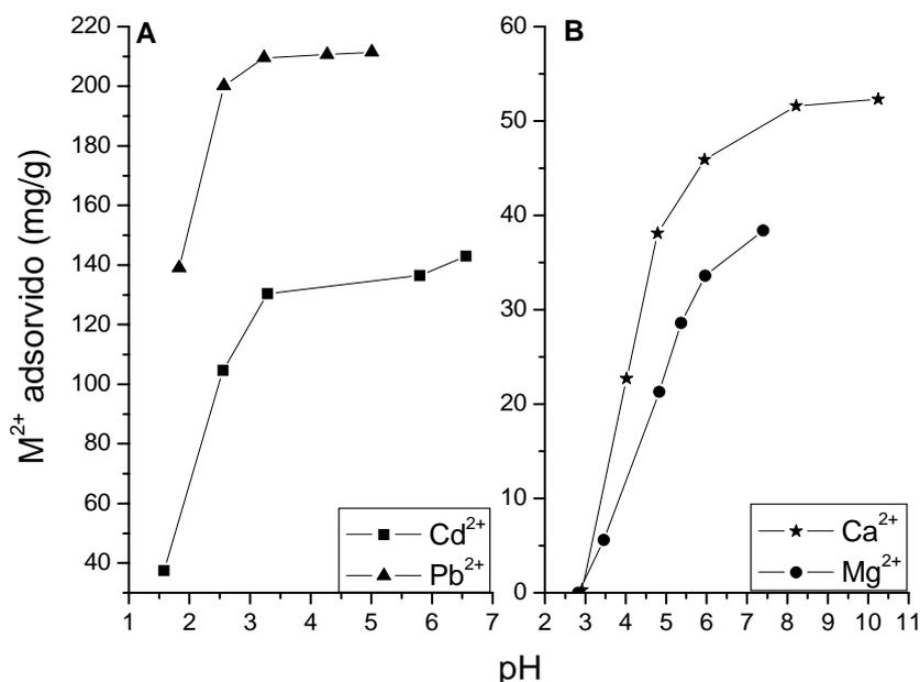
Figura 5.27. Adsorção de  $\text{Cd}^{2+}$  e  $\text{Pb}^{2+}$  (A) e  $\text{Ca}^{2+}$  e  $\text{Mg}^{2+}$  (B) em função do pH por **BTTE**.
