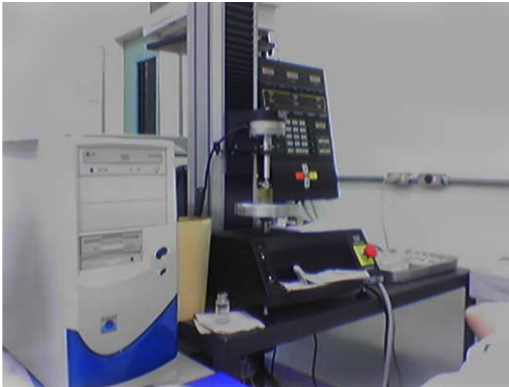
Figura 7: Máquina universal de ensaio biomecânico. Instron, modelo 4444, mostra ensaio mecânico de flexão de três pontos em mandíbula.
