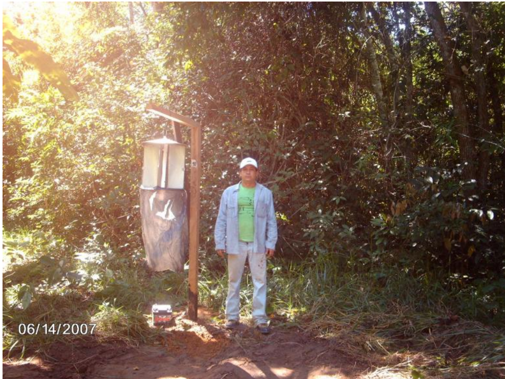
FIGURA 3 - ARMADILHA LUMINOSA LIGADA NA BATERIA E PENDURADA NO INSTRUMENTO CHAMADO “FORCA”.
