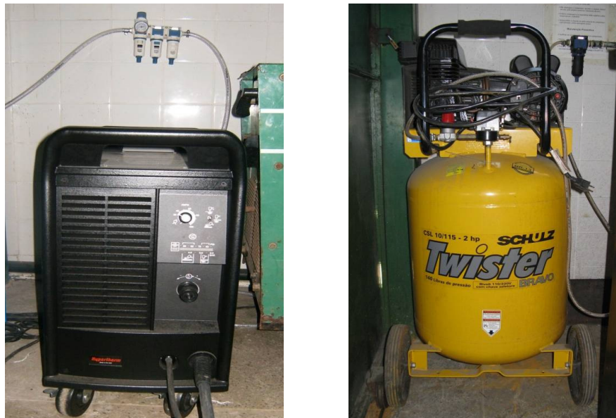
Figura 4.3 Equipamentos para processo de goivagem a arco plasma.
