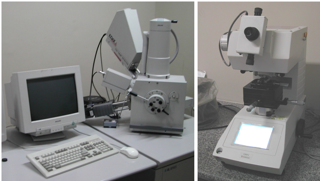
Figura 4.10 a) Microscópio eletrônico de varredura (MEV) b) Microdurômetro Vickers.
