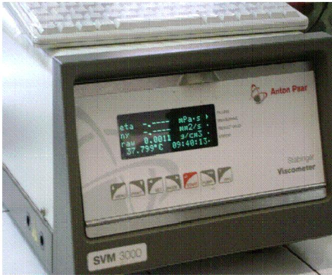
**Figura 18** – Equipamento utilizado para levantamento da curva de densidade dos LIs estudados - Stabinger SVM 3000
