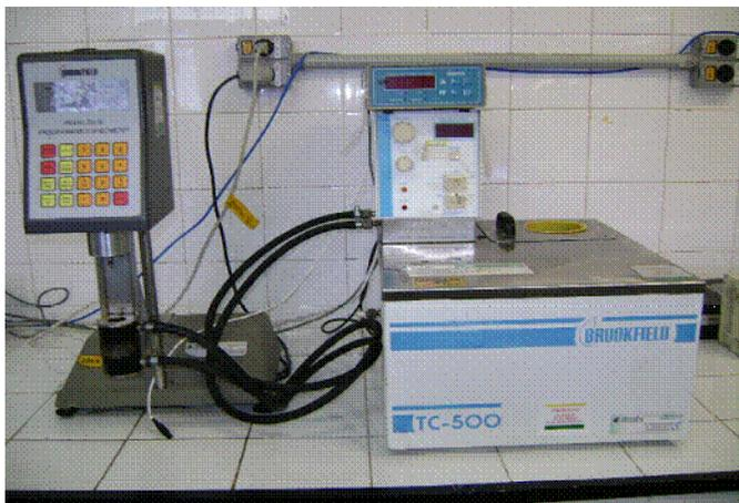
**Figura 19-** Equipamento utilizado para levantamento da curva de viscosidade dos LIs estudados - Brookfield TC-500
