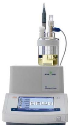
**Figura 20-** Titulador Coulometrico para determinação do teor de água dos LIs estudados
