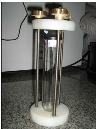
**Figura 25-** Frasco de quartzo e suporte para realização de testes sob aquecimento convencional.
