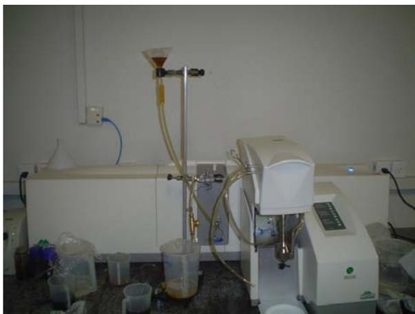
**Figura 24-** Equipamento para determinação da DTG - modelo MASTERSIZER 2000 da MALVERN
