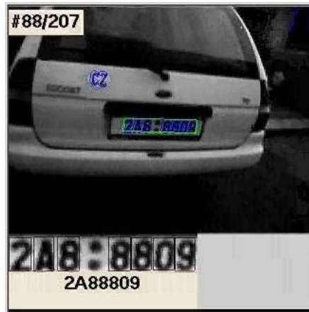
Figura 9: Exemplo de detecção e reconhecimento de placa de veículos. Retirado de (ZIMMERMANN, 2009).
