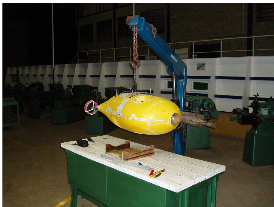
Figura 37 – Verificação e ajuste da posição do CG do veículo.
