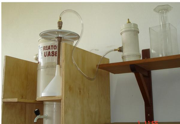
Figura 4.11 Sistema de medição do gás Metano
