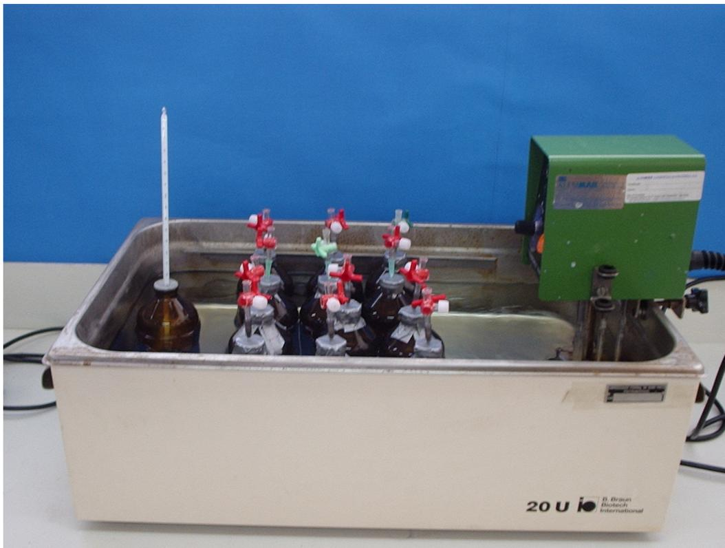
FIGURA 4.6 Frascos de reação do teste de AME
