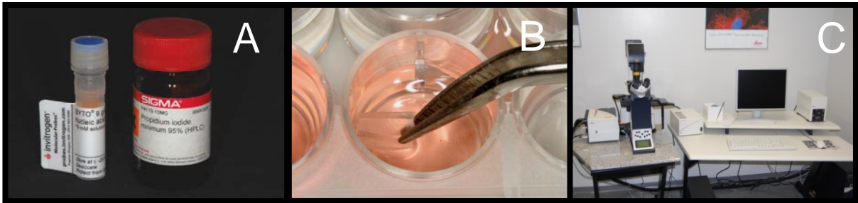
Figura 9: Processamento dos corpos-de-prova para microscopia confocal. Utilização dos fluorocromos SYTO-9 e iodeto de propídeo para análise da viabilidade celular (A) . Imersão do corpo-de-prova em 1 mL de PBS com 1 \mu\text{M} de SYTO-9 e 1 \mu\text{M} de iodeto de propídeo, aguardando-se 20 minutos na ausência de luz para a difusão dos fluorocromos (B) . Após este período, cada corpo-de-prova foi montado com a face para baixo em lâmina de vidro para análise em microscópio confocal (C) .
