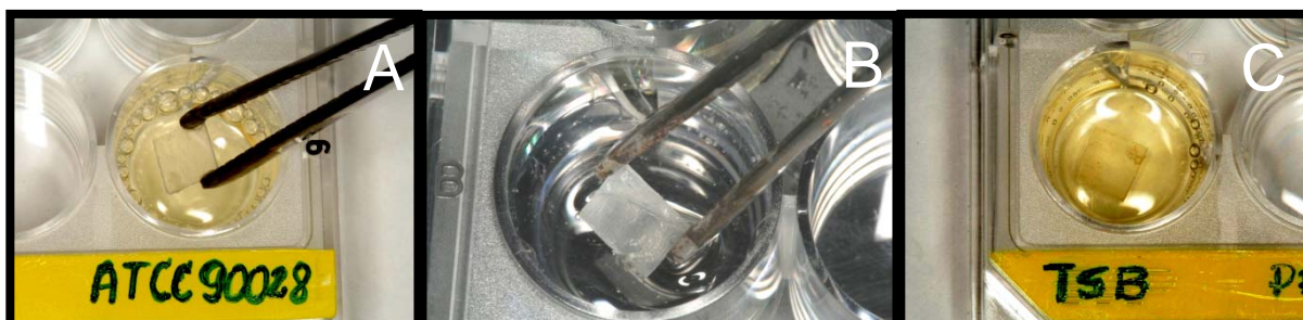
Figura 7: Formação do biofilme. Imersão do corpo-de-prova, com a face rugosa voltada para cima, em um poço da placa de cultura, contendo 1 mL do inóculo (A) . Após 90 minutos, foi realizada a lavagem do corpo-de-prova em 2 mL de PBS para a remoção das células não aderidas ao material (B) . A seguir, o corpo-de-prova foi transferido para um novo poço com 1 mL de TSB com cloranfenicol, para que houvesse a formação do biofilme por 24 horas (C) .
