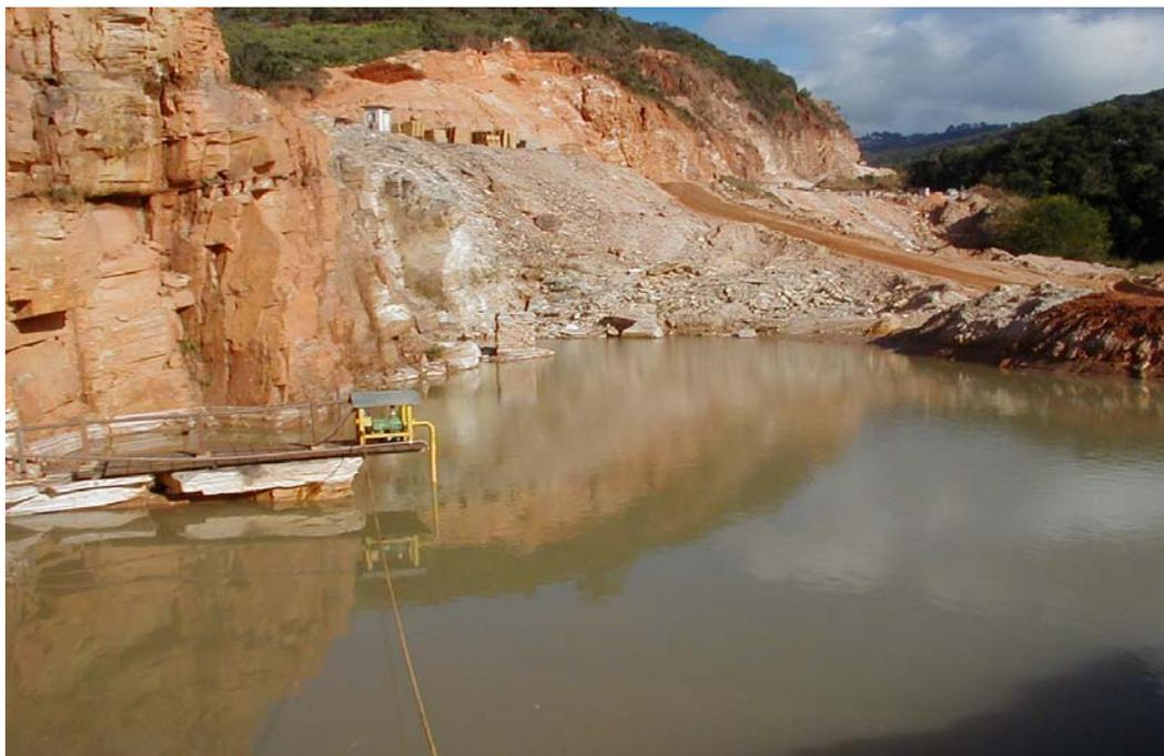
**Figura 60 – Tanque de retenção das águas finais da empresa A**
