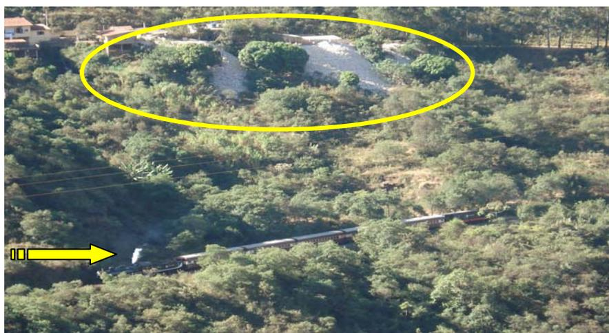
**Figura 54 – Descarte dos rejeitos sólidos nas encostas às margens da ferrovia**
