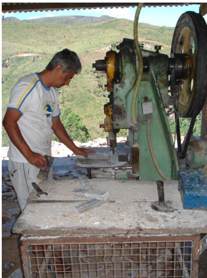
**Figura 41 – Prensa motorizada de 20 toneladas**
