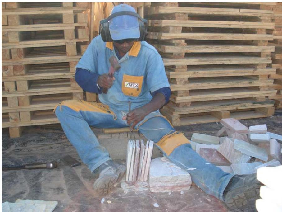
**Figura 39 – Processo de almofadar lajotas**
