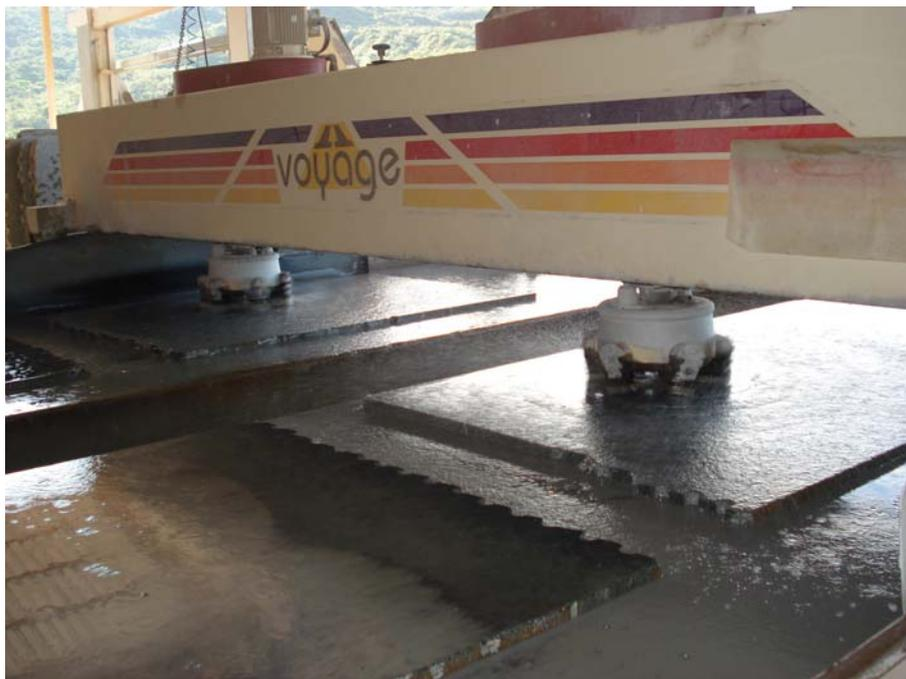
**Figura 44 - Máquina de polimento automático**
