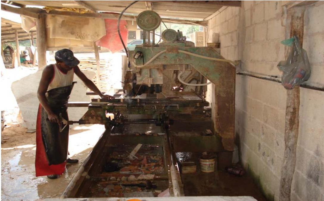
**Figura 33 – Máquina de Serrar Monobloco Móvel**
