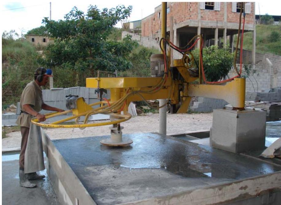
**Figura 43 - Máquina de polimento manual.**
