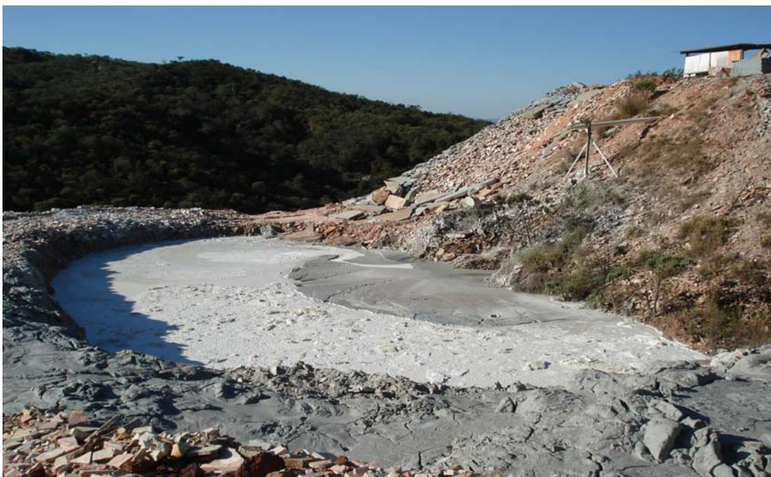
**Figura 59 – Tanque de decantação dos rejeitos finos da empresa A**
