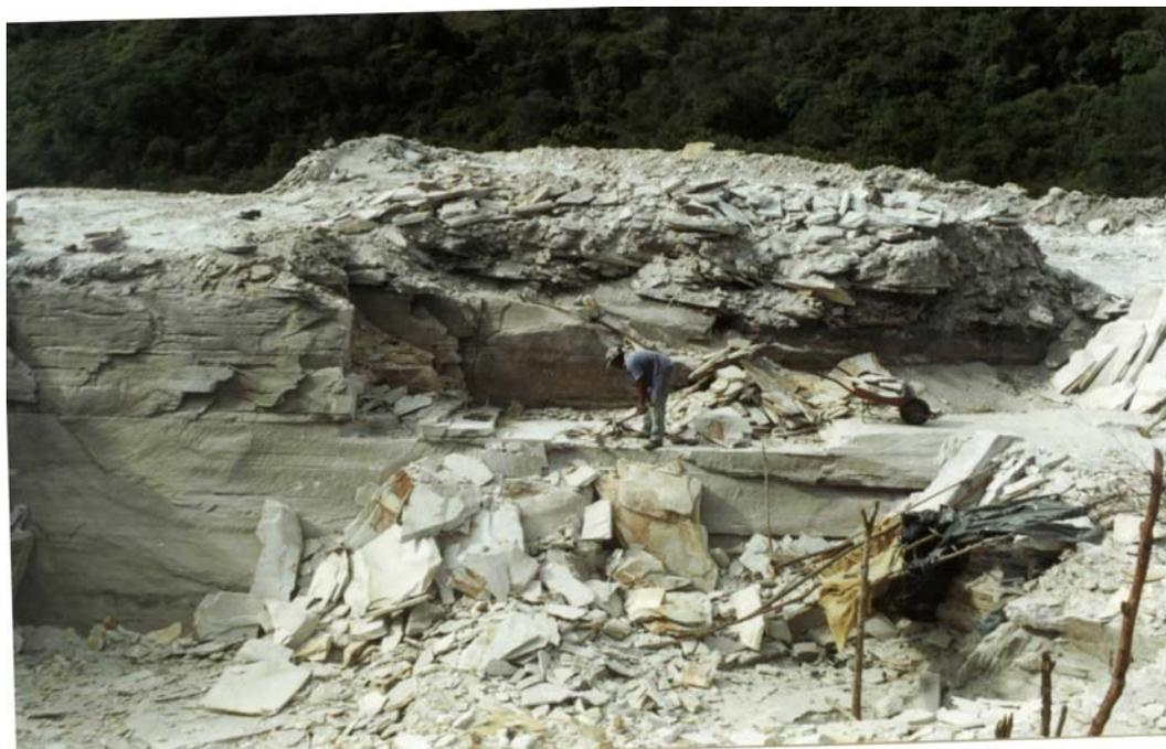
**Figura 21 – Exploração do quartzito na região de Ouro Preto, por bancos e blocos irregulares**
