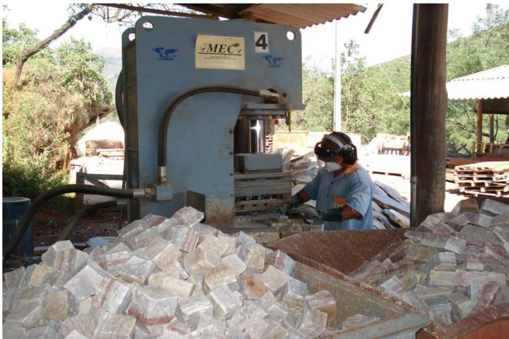
**Figura 42 – Prensa hidráulica de 60 toneladas**
