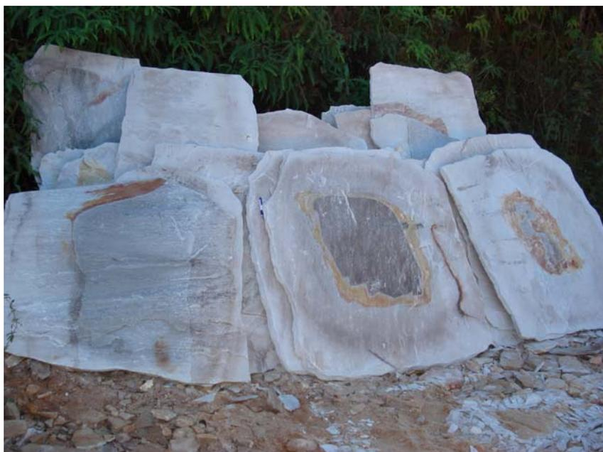
**Figura 1 – Lajões de quartzito com poucas variações de cores**
