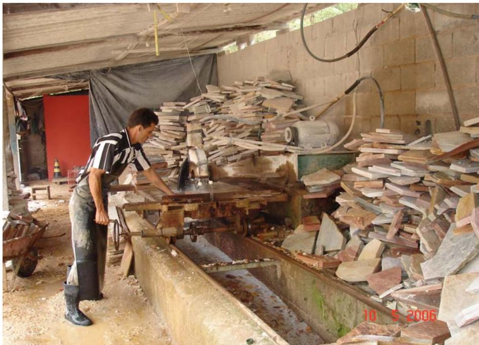
**Figura 34 – Máquina de Serrar Monobloco Fixa.**
