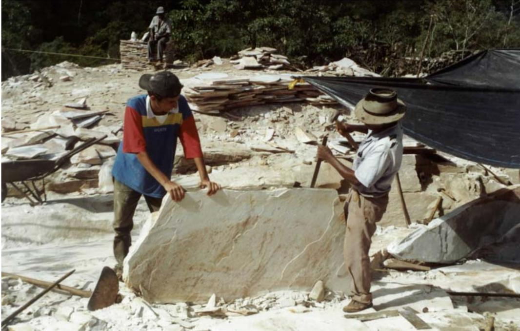
**Figura 22 – Extração manual aproveitando-se os planos de fraturas do quartzito e usando-se cunha e marreta**
