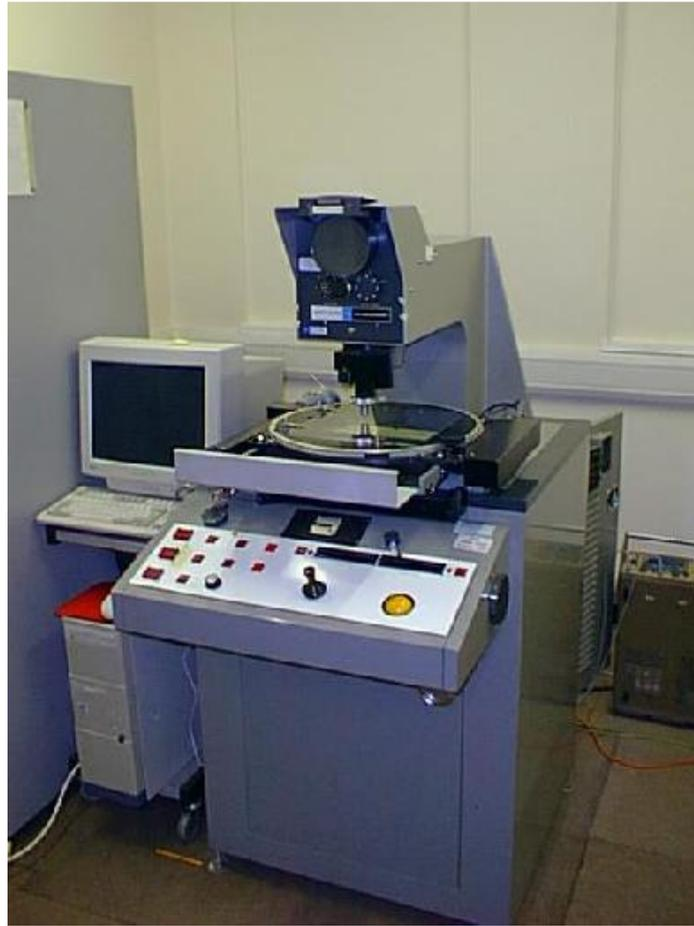
**FIG 3.1** Foto de um microdensitômetro, modelo PDS 1010A.
