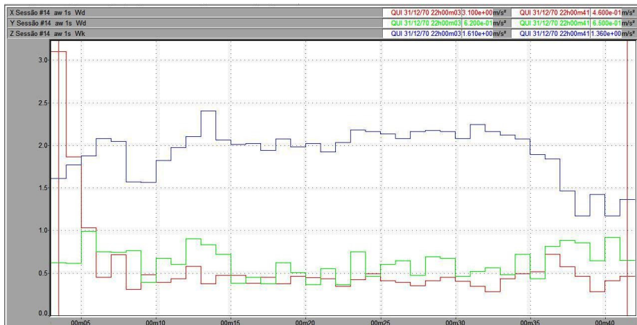
Figura 119 – Vibração no trator New Holland TS 110 no corpo inteiro, em pista de solo batido, com pressão de inflação dos pneus de 20 psi, na marcha II-3.
