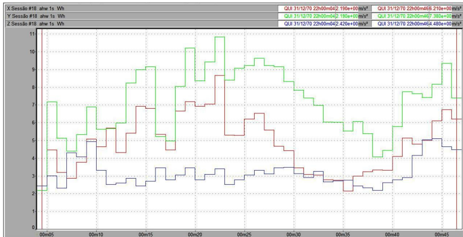
Figura 156 – Vibração no trator New Holland TS 110 no membro superior, em pista de solo firme, com pressão de inflação dos pneus de 20 psi, na marcha II-4.
