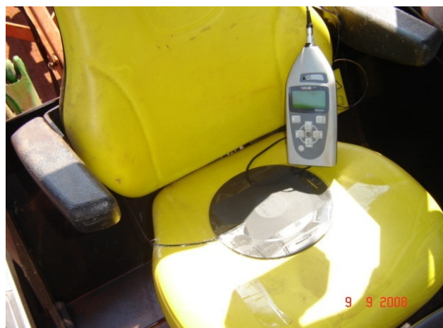
Figura 14 – Exemplo de fixação do acelerômetro, para a medição em corpo inteiro.
