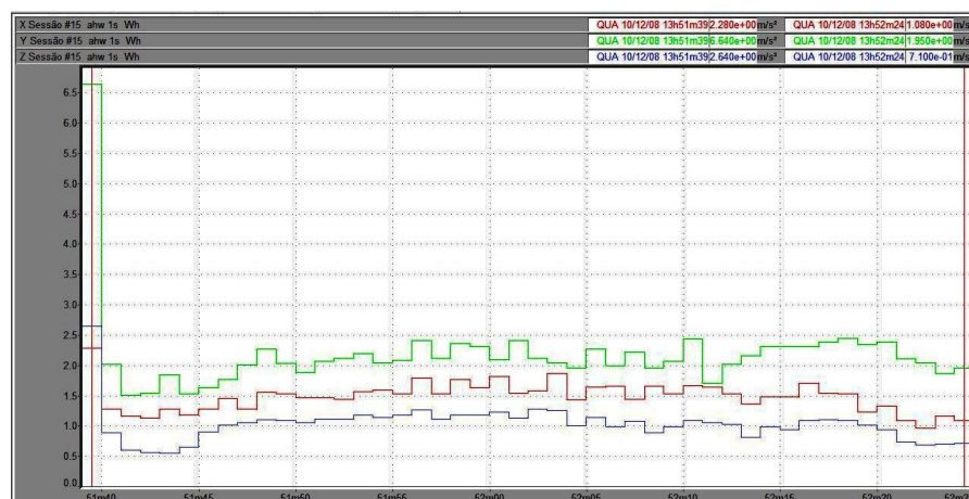
Figura 161 – Vibração no trator New Holland TS 110 no membro superior, em pista de solo firme, com pressão de inflação dos pneus de 30 psi, na marcha II-3.
