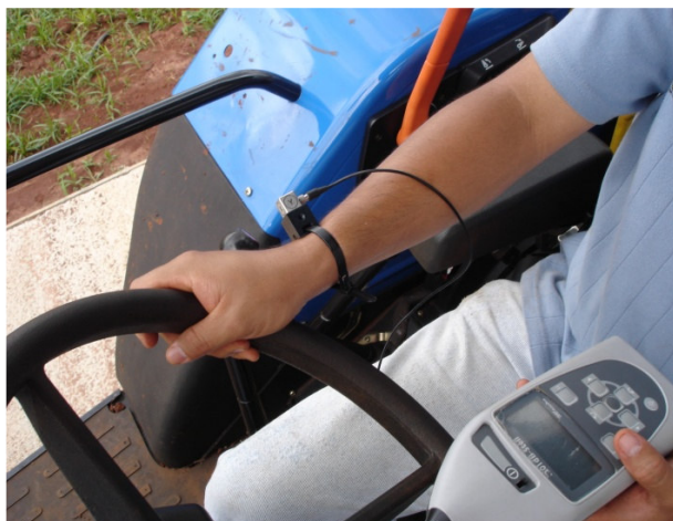
Figura 13 – Posicionamento do acelerômetro no membro superior do operador do trator.
