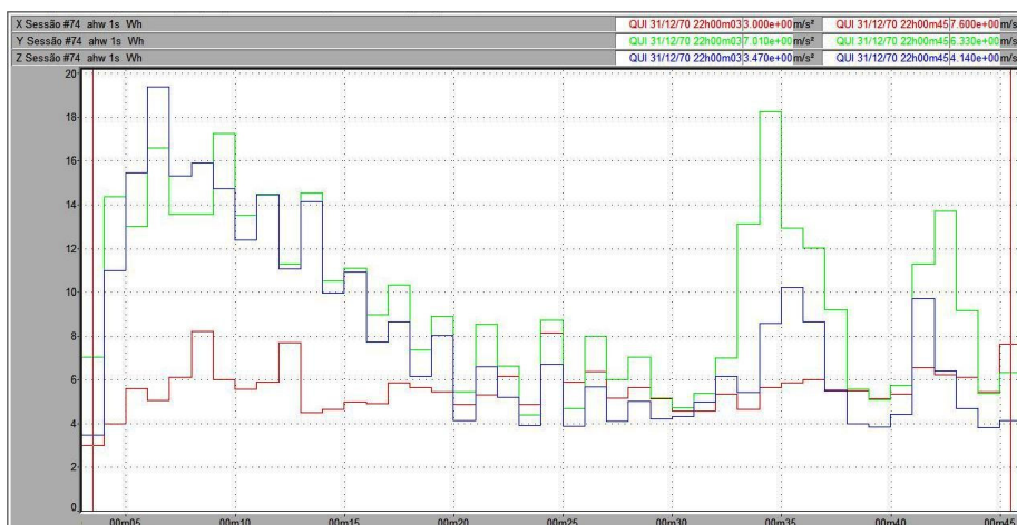
Figura 59 – Vibração no trator New Holland TL 75E no membro superior, em pista de asfalto, com pressão de inflação dos pneus de 20 psi, na marcha II-3.
