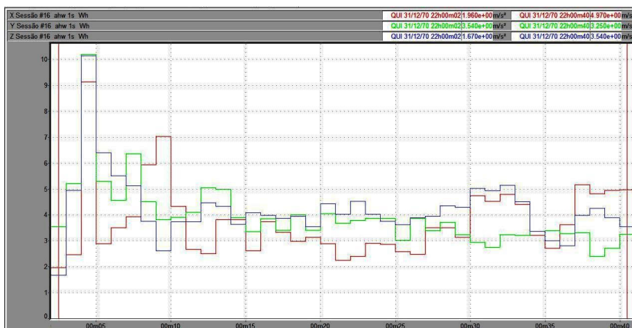
Figura 154 – Vibração no trator New Holland TS 110 no membro superior, em pista de solo firme, com pressão de inflação dos pneus de 20 psi, na marcha II-2.
