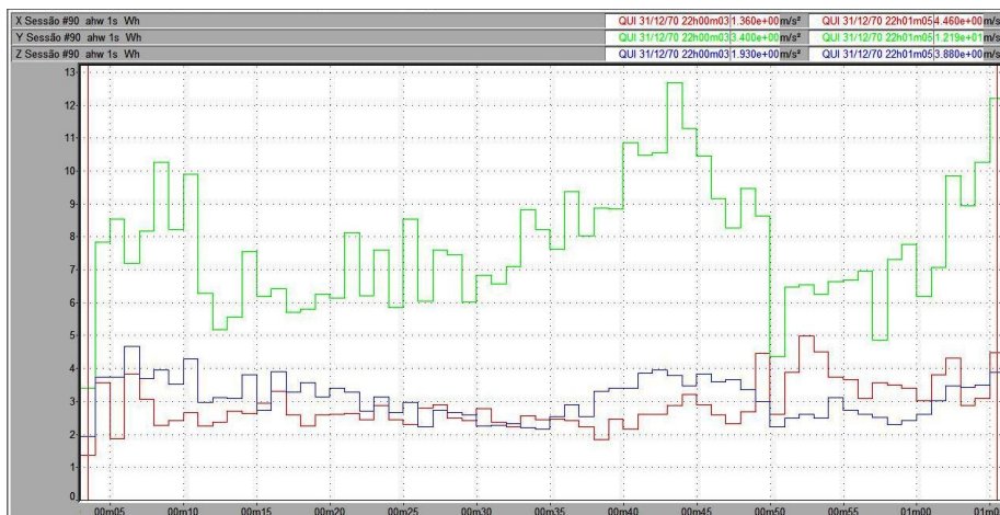
Figura 55 – Vibração no trator New Holland TL 75E no membro superior, em pista de asfalto, com pressão de inflação dos pneus de 15 psi, na marcha II-2.
