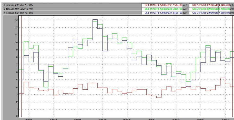
Figura 56 – Vibração no trator New Holland TL 75E no membro superior, em pista de asfalto, com pressão de inflação dos pneus de 15 psi, na marcha II-3.
