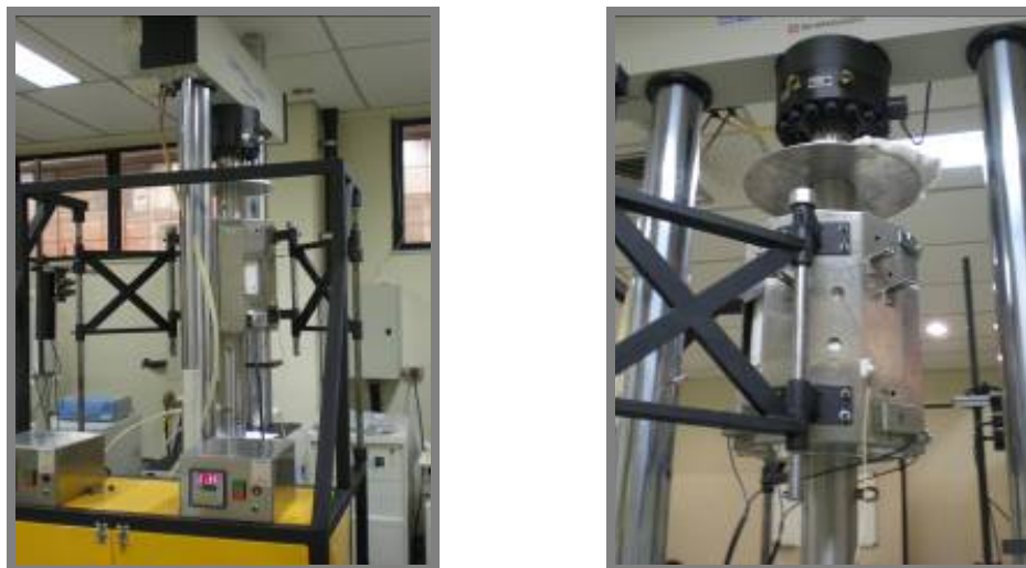
Figura 3.15: Montagem do forno para o ensaio de compressão a temperatura de 110°C.
