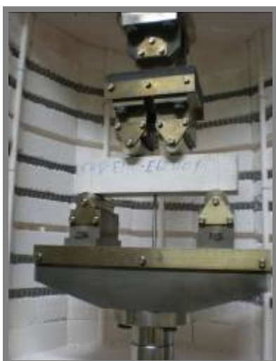
Figura 3.21: Detalhe do controle do deslocamento para ensaio sob alta temperatura (LVDT interno).
