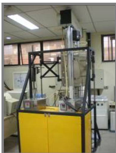
Figura 3.17: Configuração para ensaio de compressão a 600°C, com amostras de diâmetro 25 mm e comprimento 50 mm, e preparação do forno na prensa.
