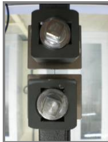
Figura 3.3: Ensaio para determinação da resistência à tração da fibra de aço utilizada.
