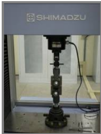
Figura 3.3: Ensaio para determinação da resistência à tração da fibra de aço utilizada.
