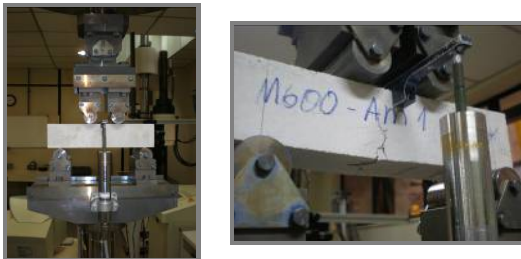
Figura 3.19: Leitura do deslocamento (deflexão) através de LVDT no ensaio a flexão.
