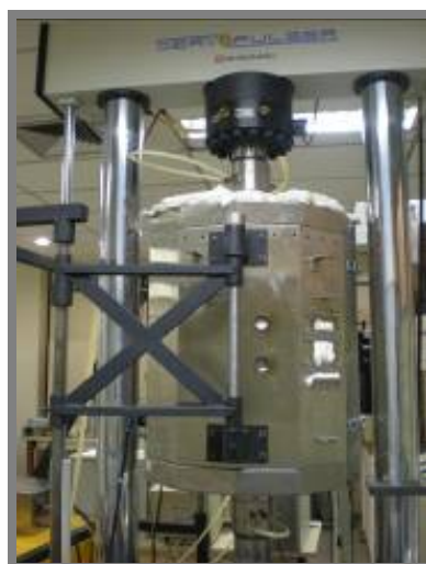
Figura 3.17: Configuração para ensaio de compressão a 600°C, com amostras de diâmetro 25 mm e comprimento 50 mm, e preparação do forno na prensa.
