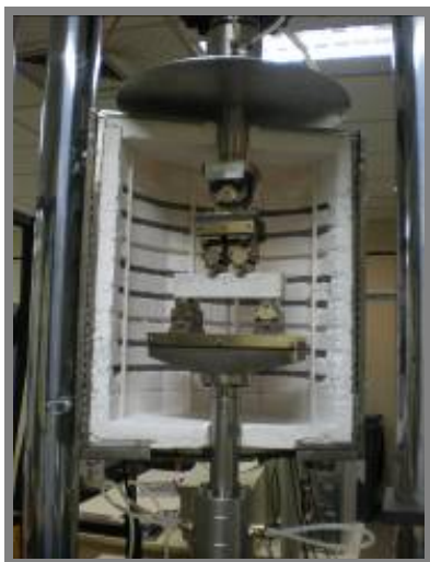
Figura 3.20: Preparação do forno para o ensaio a temperatura de 600°C.
