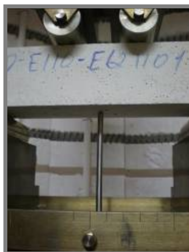
Figura 3.21: Detalhe do controle do deslocamento para ensaio sob alta temperatura (LVDT interno).
