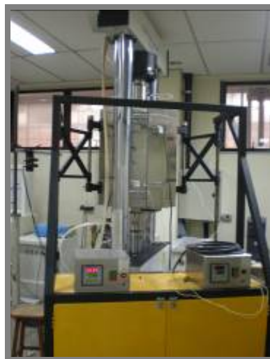
Figura 3.20: Preparação do forno para o ensaio a temperatura de 600°C.
