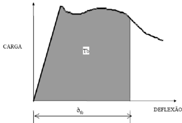
Figura 3.22: Curva carga versus deslocamento para determinação do fator de tenacidade (FT), segundo critérios da norma japonesa JSCE-SF4 (1983).
