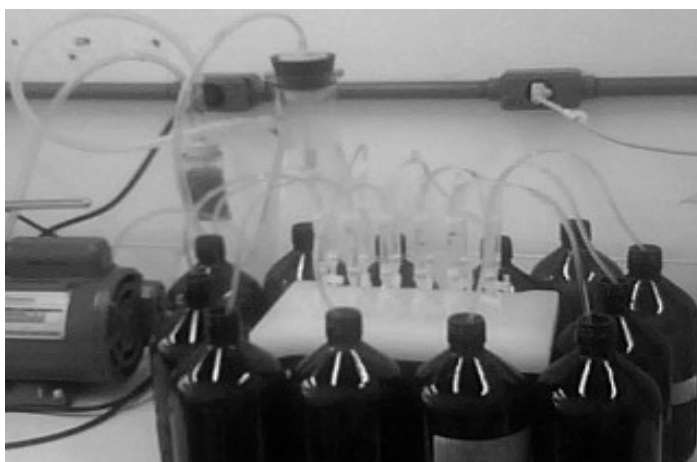
Figura 4.3 – Sistema de vácuo Manifold para a extração das amostras naturais.
