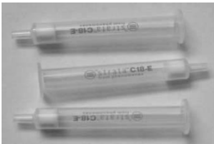
Figura 4.2 – Cartuchos utilizados na extração dos HPAs.
