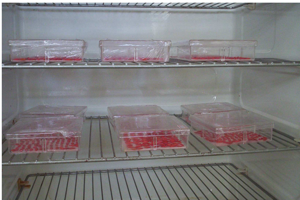
Figura 15 – Distribuição das sementes de melão ( Cucumis melo L.) cv. Orange flesh, nas caixas gerbox no interior da estufa BOD a 25°C, UFERSA, Mossoró – RN, 2006.
