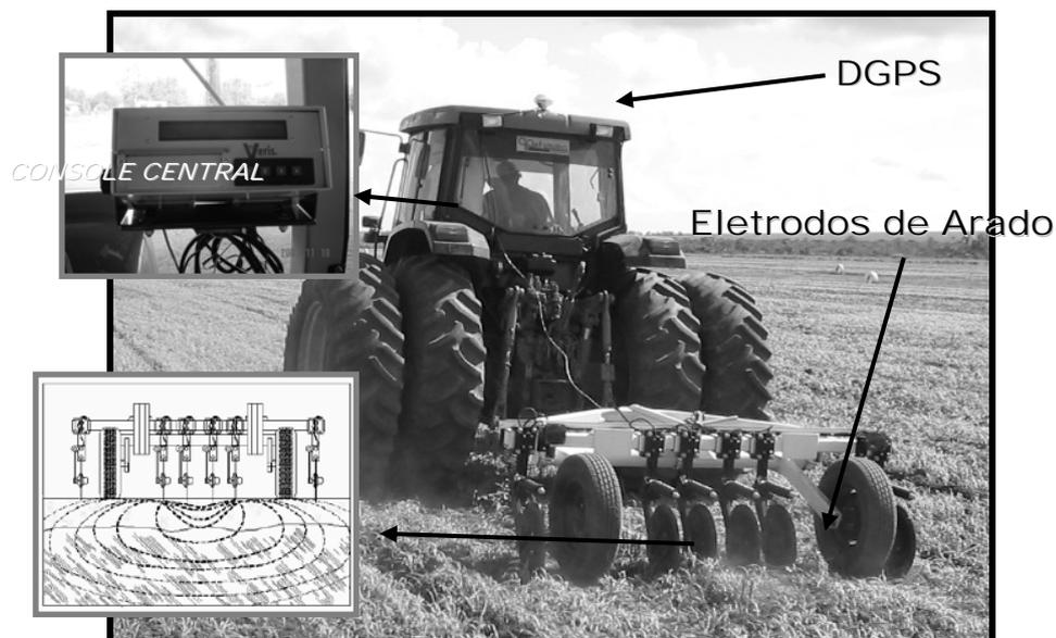
**FIGURA 3.** Obtenção da condutividade elétrica aparente do solo utilizando o equipamento Veris 3100.
