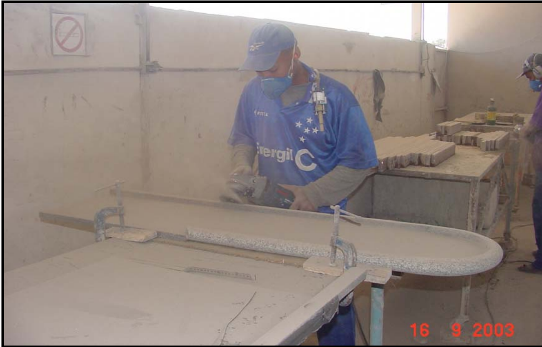
Figura 3.5 – Acabamento a seco de bordas
