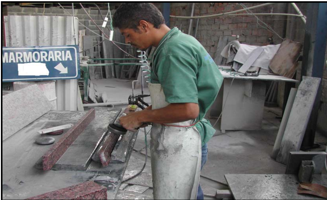
Figura 3.6 – Acabamento a úmido de bordas
