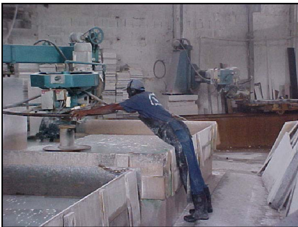
Figura 3.3 – Polimento de Chapas Utilizando Politriz Manual Com Um Cabeçote
