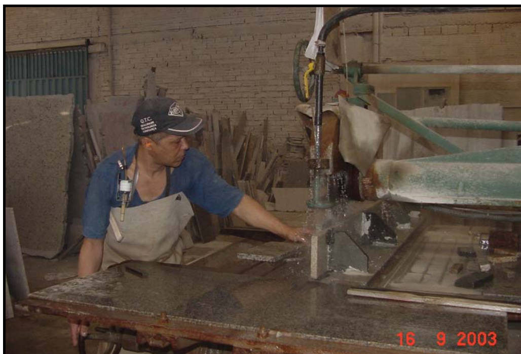
Figura 3.4 – Corte de Chapas
