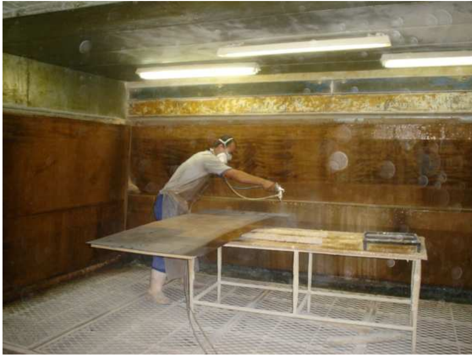
Figura 4.2 – Cabine de pintura da indústria moveleira e pistola de ar comprimido em uso
