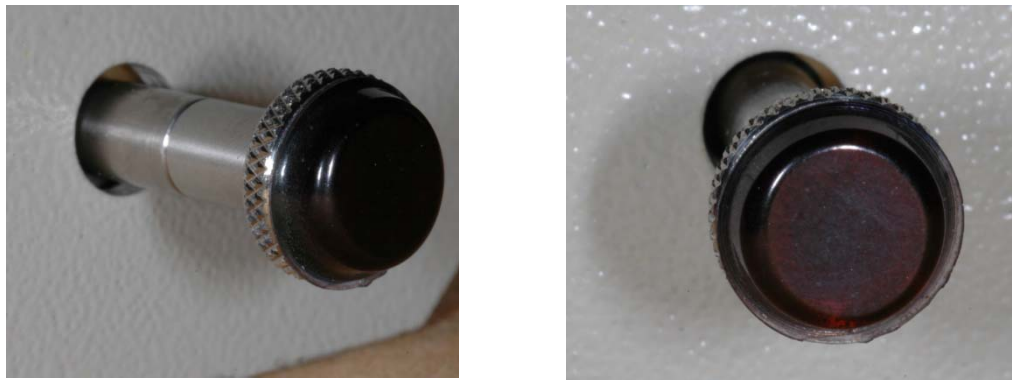
Figura 3 – Ponta circular chata que entra em contato com a pele do paciente (1 cm 2 ).
