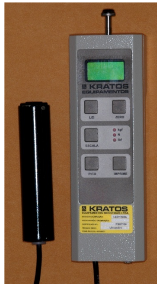
Figura 2 – Algômetro KRATOS ® utilizado para o exame de palpação.
