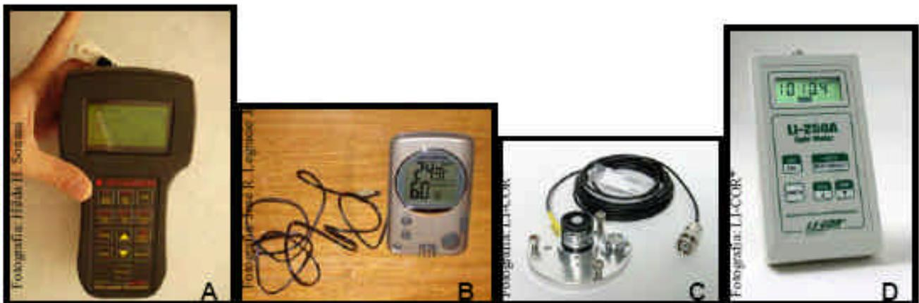
**Figura 3.** Fotografias do fluorômetro modelo OS-30P (A), do higrômetro (B), do sensor de radiação (C) e do medidor de radiação modelo LI- 250A (D)
