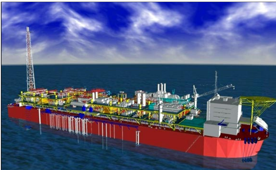
Figura 4 – FPSO com sistema de amarração através de múltiplos pontos (Fonte: Offshore Technology)
