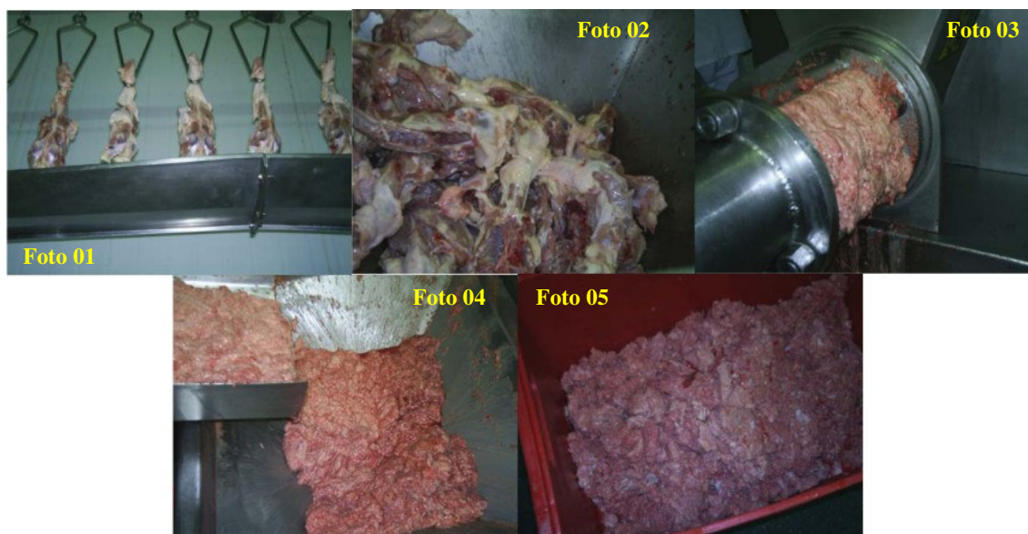
Figura 04 - Produção de Carne Mecanicamente Separada (CMS) de ave em escala industrial (Fonte: Gouvêa, 2007).
