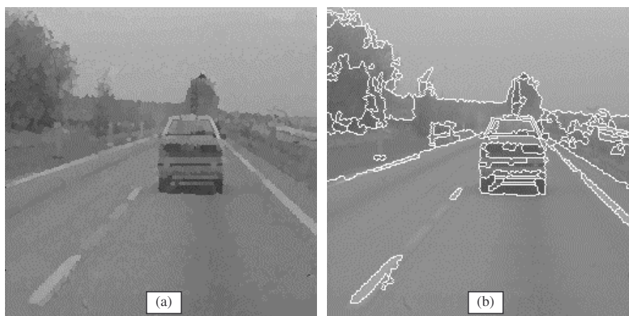
Figura A.8. (a) Imagem original; (b) Imagem com bordas detectadas.
