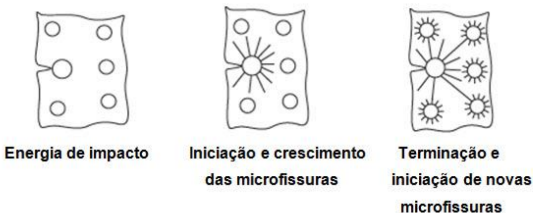
Figura 5 - Mecanismo de absorção de impacto do HIPS através do microfissuramento (GRASSI et al, 2001)
